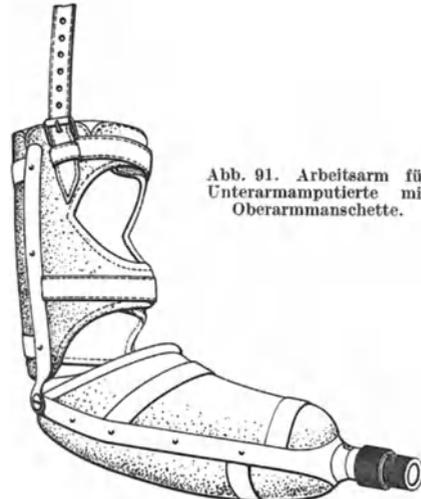
Abb. 91. Arbeitsarm für Unterarmamputierte mit Oberarmmanschette.
