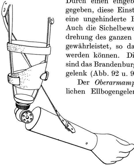
Abb. 92. Arbeitsarm für Oberarmamputierte mit Stumpfgerüst, Unterarmmanschette und künstlicher Hand, VAN PETERSEN-Zug.
