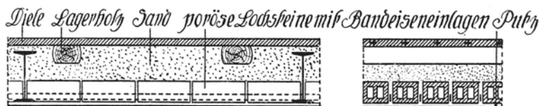
Abb. 142. Horizontale Massivdecke zwischen eisernen Trägern: System Kleine.
