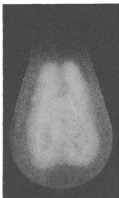
Abb. 207. Kohlenfadengluhlampe mit zu schwacher Mat- tierung der Birne.
