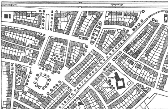
Abb. 15. Neuerer Bebauungsplan eines Wohnviertels in München-Gladbach (Stadtbaurat Greis) mit Baublocks von geringer Tiefe und hinterer Bauflucht zur Verhinderung von Seiten- und Querflügeln.
