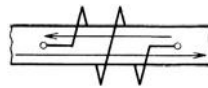
Abb. 2122m. Bei einer einlagigen, linksgewickelten Spule sind zwei verschiedene Bezugspfeile nötig, um die Bezugssinne der Wicklung und des magnetischen Kernes richtig anzugeben.
