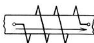
Abb. 2122l. Bei einer einlagigen, rechtsgewickelten Spule können der Bezugssinn der Wicklung und des Kernes durch einen einzigen Bezugspfeil richtig angegeben werden.
