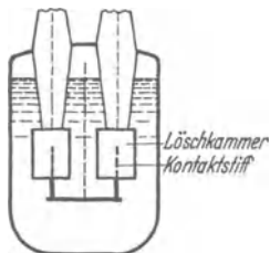
Abb. 275. Ölschalter mit Löschkammer.
