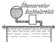
Abb. 161. Schematische Anordnung des Buchholz-Schutzes.
