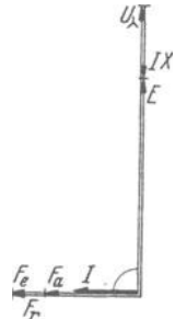
Abb. 74. Generatordiagramm bei rein kapazitiver Belastung.
