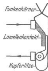
Abb. 258. Schalter mit Lamellenkontakt und Funkenhörnern.
