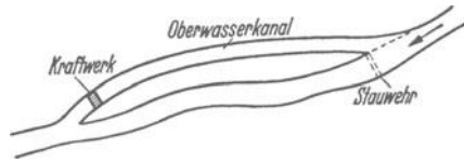
Abb. 32. Schematische Darstellung eines Laufkraftwerkes mit Oberwasserkanal.
