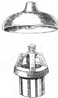
Fig. 45. Zweiteiliger Einführungskopf für Dachständer.
