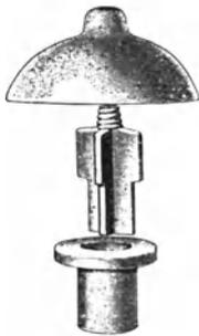
Fig. 44. Dreiteiliger Einführungskopf für Dachständer.
