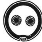
Fig. 129. Gummiaderleitung in 11er Papierrohr.
