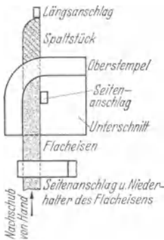
Abb. 111. Spaltwerkzeug Abb. 110 eingebaut; Schema, Draufsicht.
