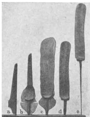
Abb. 122. Herstellung eines Tischmessers. a Spaltstück; b Kropf und Angel geschlagen; c Klinge ausgeschmiedet; d Klinge abgegratet; e Angel verlängert.
