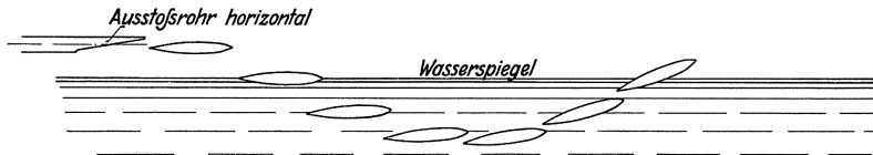
Fig. 99. Verlauf der Anfangsbewegung eines Torpedogeschosses bei Horizontal-lage des Ausstoßrohres.
