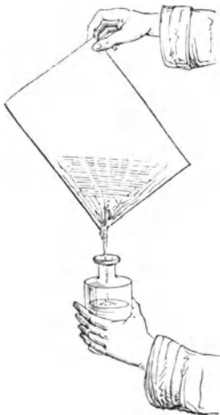
Fig. 190. Abgießen des Collodiums.
