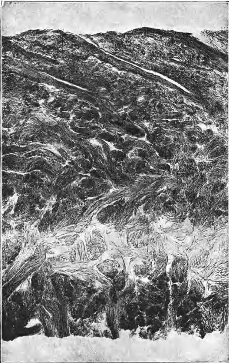
Abb. 148. Vertikalschnitt durch ein amerikanisches „Chrome retan army upperleather“
