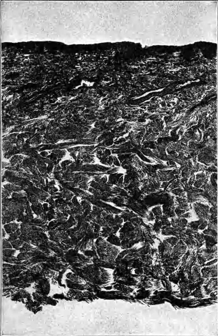
Abb. 106. Vertikalschnitt durch Roßleder
