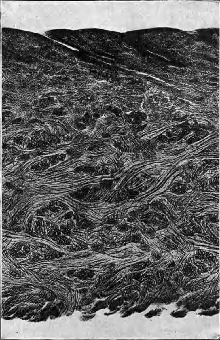
Abb. 143. Vertikalschnitt durch Kalbsleder
