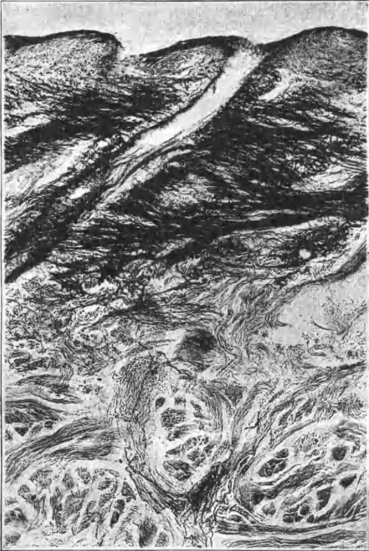
Abb. 82. Vertikalschnitt durch die Thermostatschicht einer Kalbsblöße
