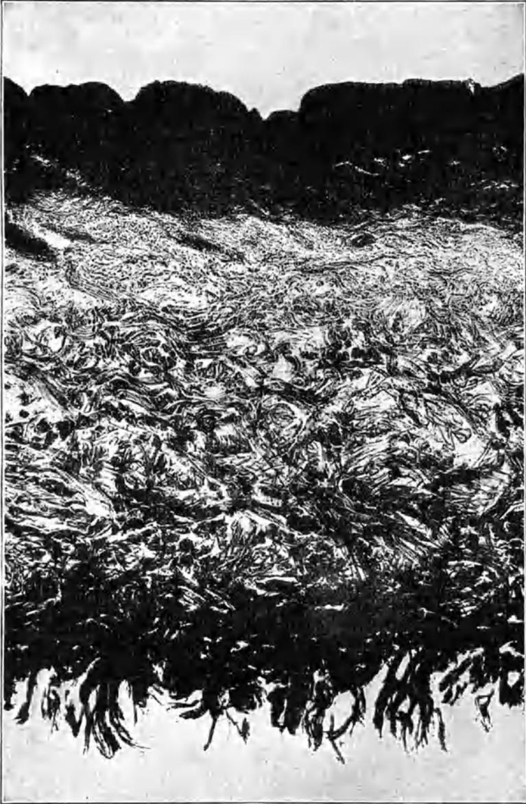
Abb. 147. Vertikalschnitt durch Kalbleder
