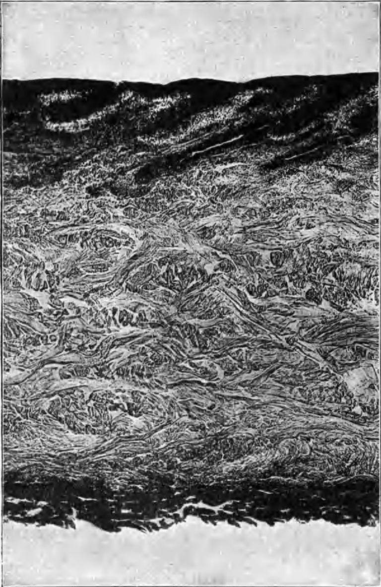
Abb. 144. Vertikalschnitt durch Kalbleder
