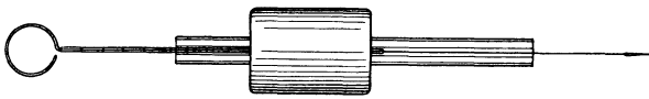
Abb. 25. Stachelborste zur Messung von Schmerzschwellen bei kleinster Reizfläche. \frac{3}{4} der natürl. Größe. Nach v. FREY.
