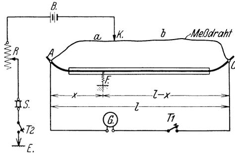
Abb. 393. Fehlerortsbestimmung (Erdschluß beim Einleiterkabel).
