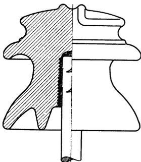
Abb. 148. Verstärkter Stützenisolator, genormte Form.
