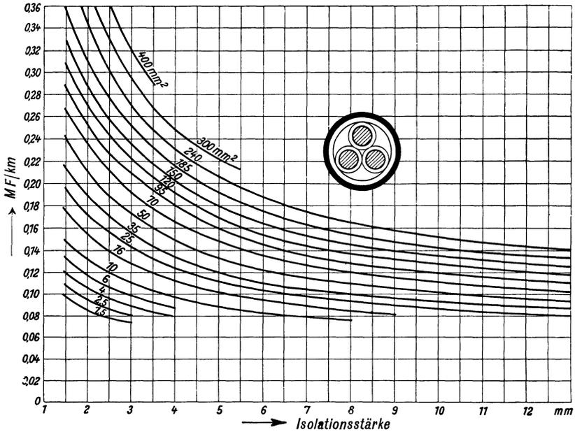
Abb. 343. Teilkapazität Leiter-Bleimantel  $c_{10}$  von Dreileiterkabeln mit Gürtelisolierung und runden Leitern.
