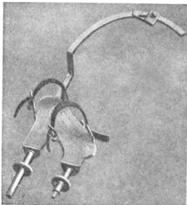
Abb. 241. Steigschuh für Schleuderbetonmaste.
