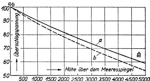
Abb. 144. Überschlagspannung eines Isolators in Abhängigkeit von der Höhe über dem Meeresspiegel.
