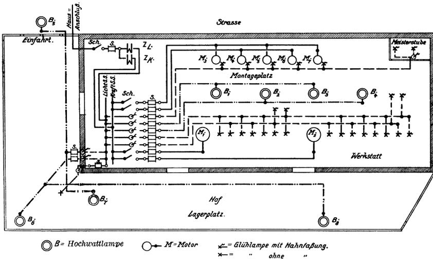
Abb. 3. Leitungsplan für die elektrische Kraft- und Lichtanlage in einer Fabrik.
