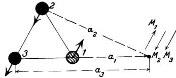
Abb. 102. Induktionswirkung einer Drehstromleitung auf einen Fernmeldeleiter.
