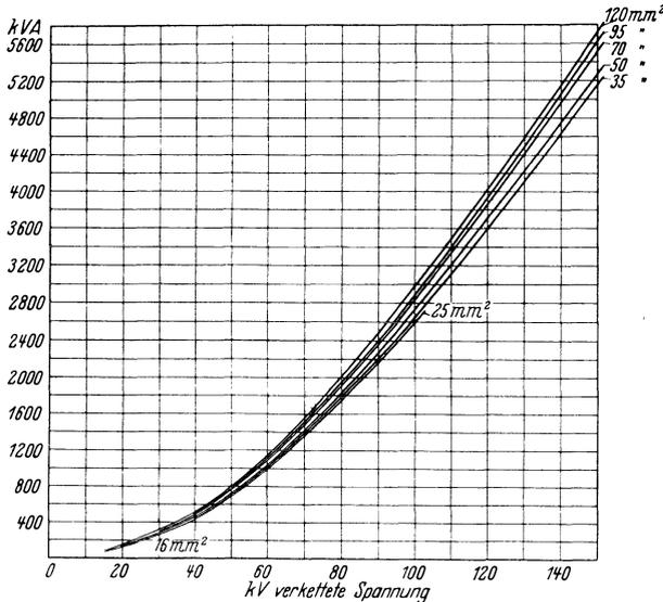
Abb. 84. Kennlinien für die Kapazitätsbelastung von Kraftwerken durch die Ladeleistung der Freileitungen (Drehstrom,  $f = 50$ , 100 km Länge, übliche Leiterabstände, Dreieckanordnung).
