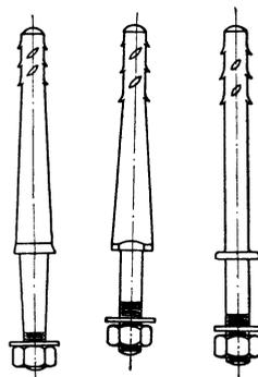
Abb. 151. Verschiedene Formen gerader Stützen.
