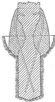
Abb. 199. Mit Eisenstäben und Beton ausgebesserter Fuß bei Holzmasten.
