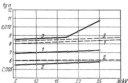
Abb. 332. Verlustwinkelverlauf für verschiedene Spannungen und Temperaturen bei einem 10-kV-Gürtelkabel (—) und metallisierten Drei-Einleiterkabel (- - -).  $3 \times 50 \text{ mm}^2 \text{ Cu}$ , Isolation 2,5 + 2,5 mm bei  $f = 50$  Hertz.
