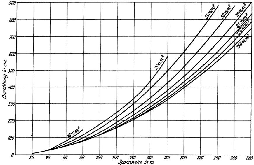
Abb. 133. Durchhang von Kupferseilen  $\sigma_{\max} = 19 \text{ kg/mm}^2$ . (Stärkster Durchhang der Seile teils bei  $-5^{\circ}\text{C}$  + VSF-Zusatzlast, teils bei  $+40^{\circ}\text{C}$ , Höchstzugspannung teils bei  $-20^{\circ}\text{C}$  ohne Zusatzlast, teils bei  $-5^{\circ}\text{C}$  + VSF-Zusatzlast.)
