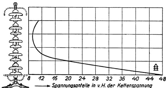
Abb. 171. Spannungsverteilung an einer 5gliedrigen Kette aus Vollkernisolatoren mit 2 Porzellanschirmen (die Schutzvorrichtungen bewirken keine merkliche Änderung der Spannungsverteilung).
