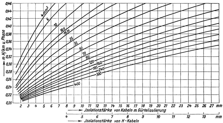
Abb. 337. Induktivität je Phase von Dreileiterkabeln.
