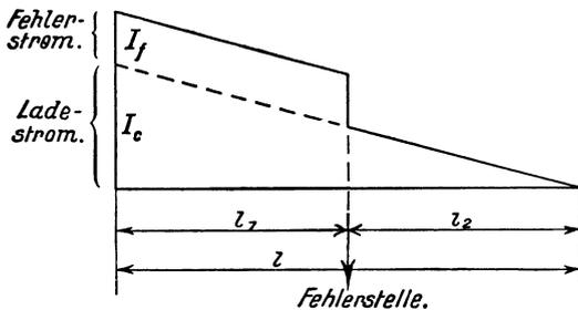
Abb. 77. Gestörter Betrieb (Erdschluß).
