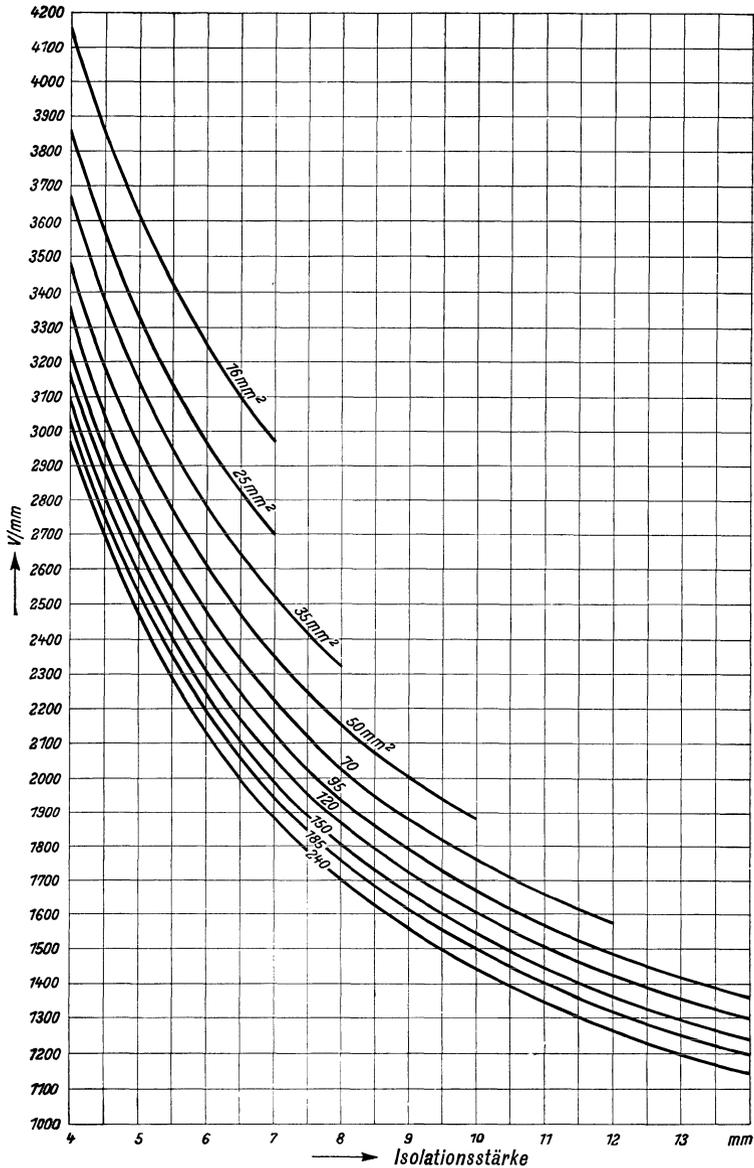
Abb. 326. Höchstbeanspruchung von Einleiter- und H-Kabeln für eine Spannung von 10000 V eff., Leiter-Bleimantel.
