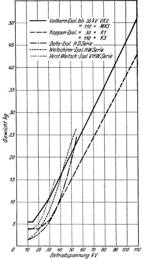
Abb. 153. Gewichtvergleich für Stützen- und Kettenisolatoren.
