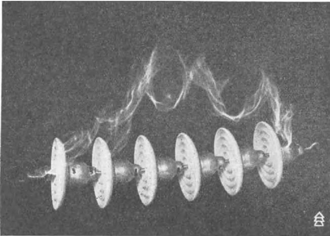
Abb. 165. Spannungsüberschlag an einer Abspannkette.
