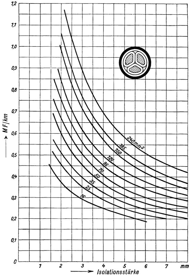
Abb. 344. Teilkapazität Leiter-Bleimantel  $c_{10}$  von Dreileiterkabeln mit Gürtelisolierung und Sektorleitern.
