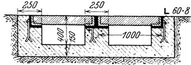
Abb. 363. Doppelkanal mit Plattenabdeckung.
