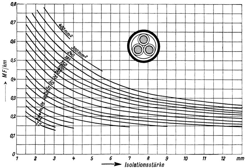
Abb. 341. Betriebskapazität  $C_b$  je Phase von Dreileiterkabeln mit Gürtelisolierung und runden Leitern.
