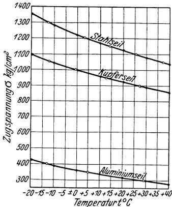
Abb. 137. Zugspannungen bei verschiedenen Temperaturen zum 26. Beispiel.
