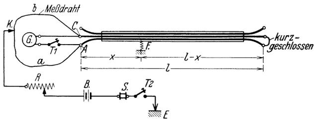
Abb. 394. Fehlerortsbestimmung (Erdschluß beim Mehrleiterkabel).
