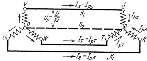
Abb. 36. Dreiphasenanlage (Stern-Sternschaltung mit Nulleiter).
