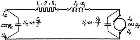
Abb. 80. Einphasen-Wechselstromleitung mit Ohmschem Widerstand, Selbstinduktion und Kapazität.
