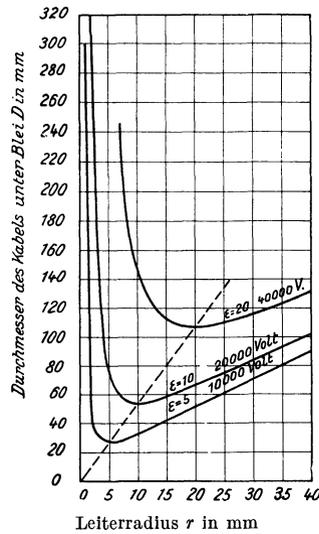
Abb. 323. Kabeldurchmesser in Abhängigkeit vom Leiterradius für verschiedene Werte von  $\epsilon$ .
