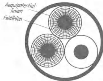
Abb. 298. Feld- und Äquipotentiallinien im Dreileiter-H-Kabel.
