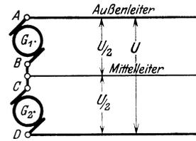
Abb. 20. Bildung eines Dreileiternetzes durch zwei Zweileitergeneratoren.
