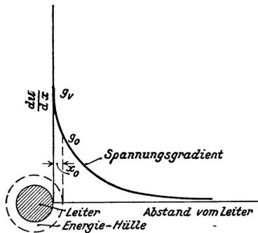
Abb. 86. Kennlinie der dielektrischen Beanspruchung der Luft um einen Leiter.
