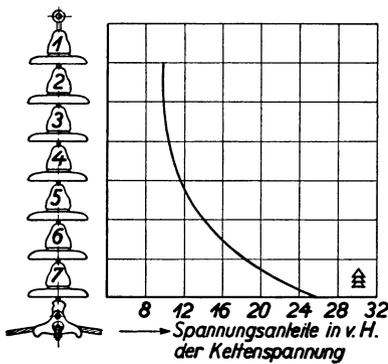
Abb. 166. Spannungsverteilung an einer 7-gliedrigen Kette aus Kappenisolatoren (ohne Schutzvorrichtungen).
