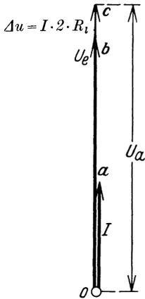
Abb. 23. Induktionsfreie Belastung.
