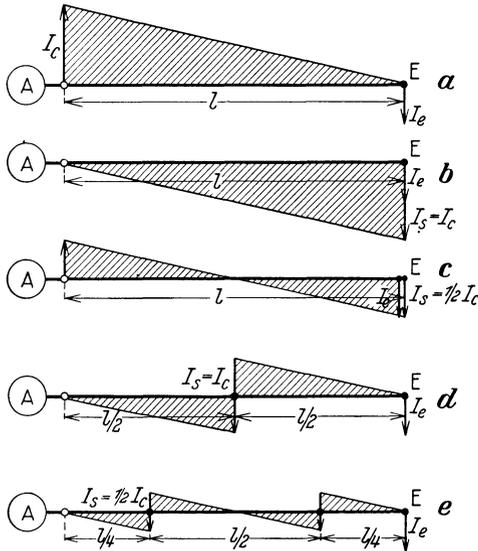
Abb. 351e der Fall gezeichnet, daß 2 Drosselspulen von je  $I_S = \frac{1}{2} I_C$  in je  $\frac{1}{4}$  Kabellänge vom Anfang und Ende gemessen gewählt werden. Dann ist:
