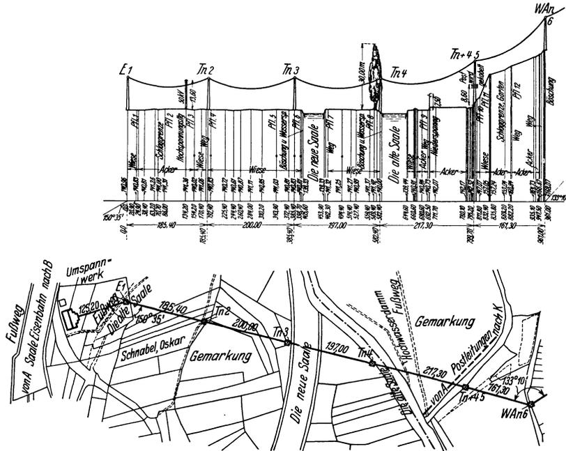
Abb. 107. Streckenplan für einen 100 kV-Freileitungsabschnitt.
