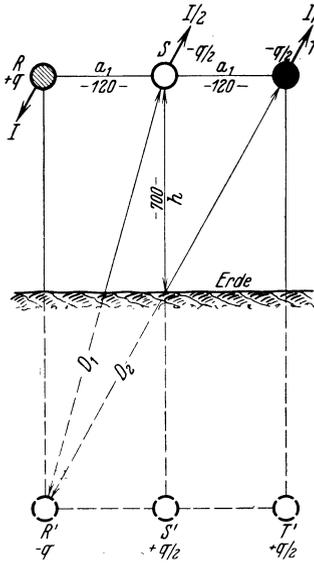
Abb. 69. Kapazitätsverhältnisse einer Drehstromleitung (unsymmetrische Leiteranordnung).
