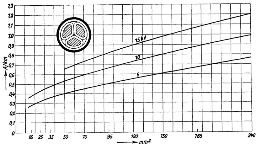
Abb. 348. Ladestrom je Phase bei Betriebsspannung  $U$  von Dreileiterkabeln mit Gürtel-isolation und Sektorleitern.
