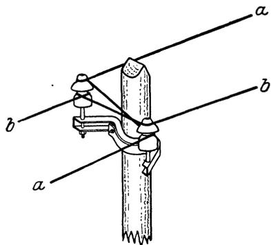
Abb. 289. Isolatorträger und Verdrillung einer Betriebs-Fernsprechleitung.
