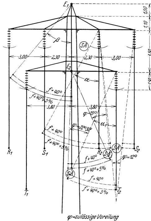
Abb. 243. Seilausschwingungs- und Seilabstandsermittlung für eine Drehstrom-Doppelleitung.
