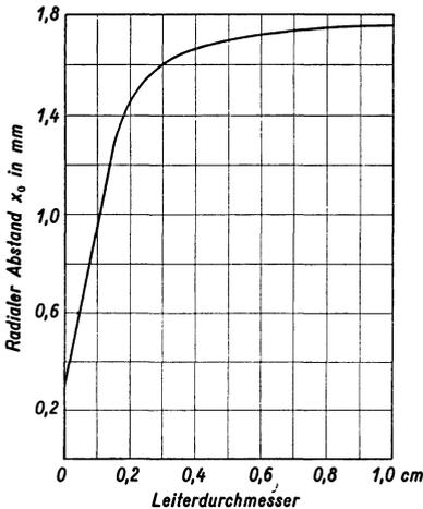
Abb. 87. Verlauf der kritischen Schlagweite bei Zylinderelektroden.
