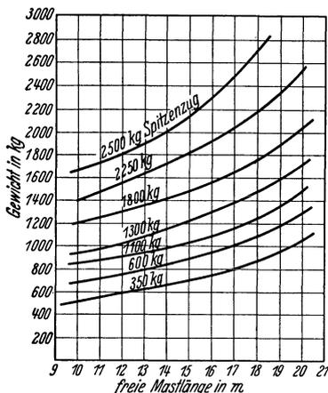
Abb. 281. Gewichte von Stahlgittermasten mit Schwellenfundament bei verschiedenen Spitzenzügen.
