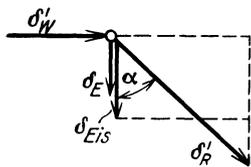
Abb. 130. Seilbelastung durch Eigengewicht, Eislast und Winddruck; Seilabtrieb.
