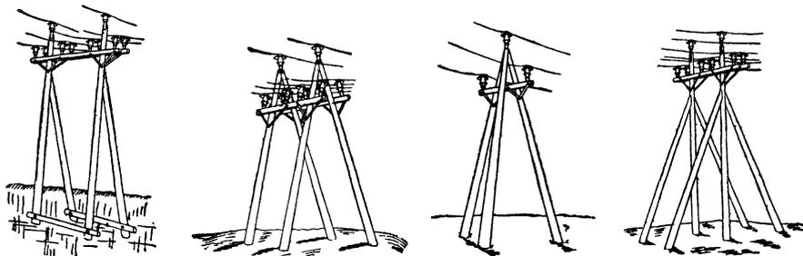
Abb. 201. Zusammengesetzte Holzmaste für Stützenisolatoren in Dreieckanordnung.
