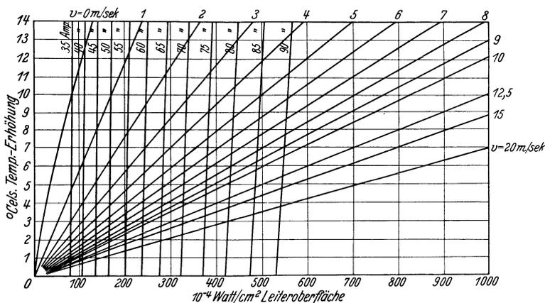
Abb. 132. Seilübertemperatur in Abhängigkeit von der Heizleistung und Windgeschwindigkeit.
