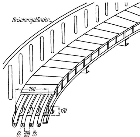
Abb. 360. Kabelkanal über eine Brücke mit Kabelverlegung, Zementformsteine, Holzbohlenabdeckung.
