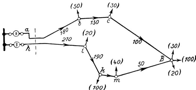
Abb. 17. Nördliche Hälfte des vermaschten Netzes der Abb. 15.
