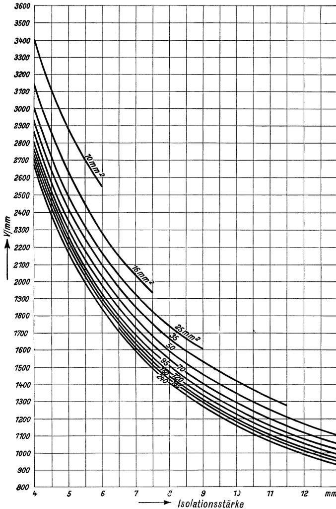
Abb. 324. Höchstbeanspruchung zwischen den Leitern bei Dreileiterkabeln mit Gürtelisolierung für eine Spannung von 10000 V eff.
