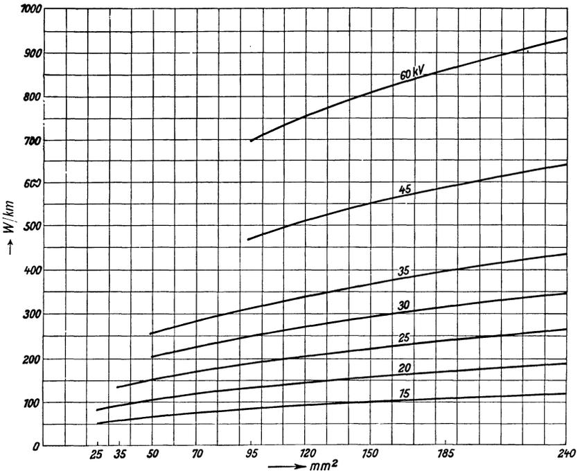
Abb. 335. Dielektrische Verluste je Phase von Einleiterkabeln bei Betriebsspannung  $U$ .
