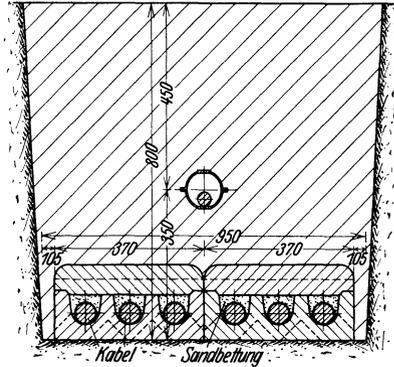
Abb. 359. Kabelkanalquerschnitt der 50-kV-Einleiterkabelstrecke des E.W. der Stadt Zürich.
