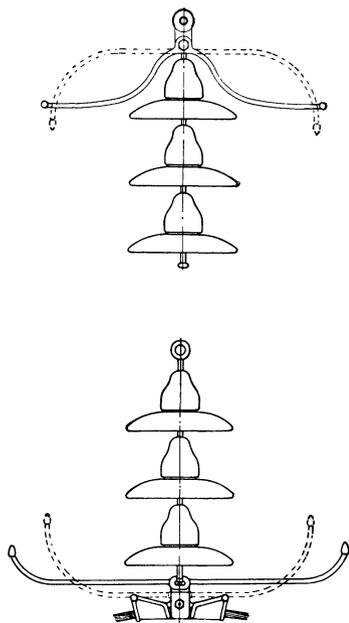
Abb. 179. Richtige und falsche (punktierte) Gestaltung einfacher Schutzhörner an einer Hängekette nach Draeger.
