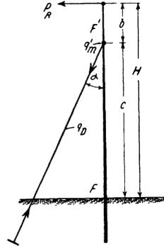
Abb. 253. Mast mit Druckstrebe.
