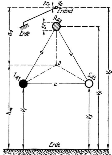
Abb. 75. Symmetrische Drehstrom-Einfachleitung mit Erdseil.
