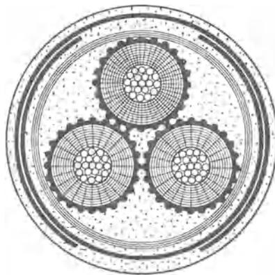
Abb. 302. Versilltes Drei-Einleiterkabel (Dreimantelkabel) mit Rillenbleimantel; Feld- und Äquipotentiallinienverlauf.
