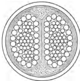
Abb. 309. Zweileiterkabel mit Leitern in Segmentform.
