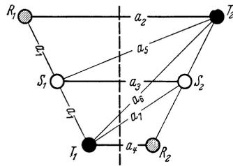
Abb. 57. Drehstrom-Doppelleitung (umgekehrte Tannenbaumform).
