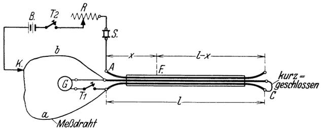
Abb. 395. Fehlerortsbestimmung (Aderschluß).
