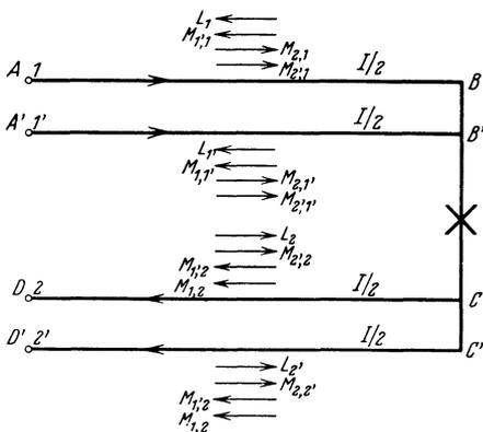
Abb. 45. Richtung der Induktionsströme bei einer Einphasen-Doppelleitung.
