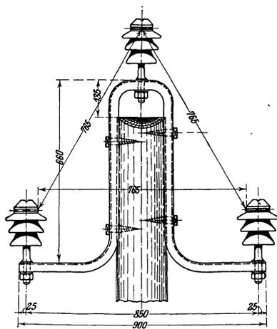
Abb. 213. Lyratraverse der Siemens-Schuckert-Werke.
