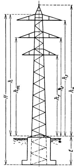
Abb. 245. Stahlgittermast mit Betonblockfundierung.
