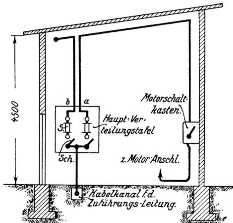
Abb. 14. Gebäudequerschnitt zu Abb. 12 für die Beurteilung der Steigleitungen.
