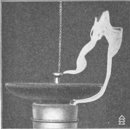
Abb. 168. Überschlag eines Kappenisolators bei Wechselfspannung.
