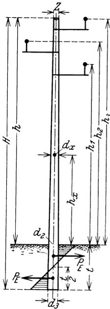
Abb. 251a. Einfacher Holzmast ohne besondere Fundierung.
