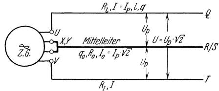
Abb. 29. Verketteter Zweiphasen-Wechselstromkreis.
