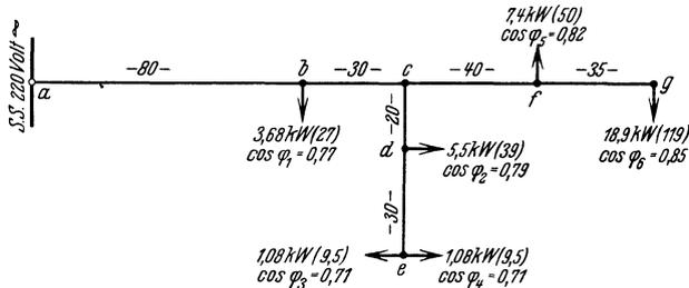
Abb. 26. Beispiel für die Berechnung einer mehrfach belasteten Wechselstrom-Einphasenleitung.
