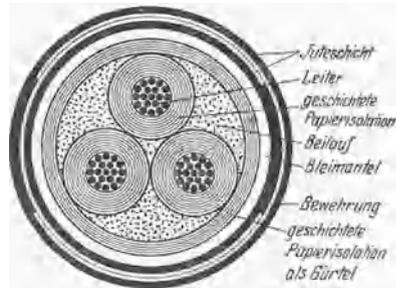
Abb. 292. Dreileiter-(Drehstrom-)Gürtelkabel Form NKBA.
