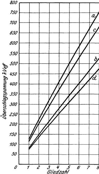
Abb. 172. Mindest-Überschlagsspannungen an Kettenisolatoren (Vollkernisolatoren MK 5 als Hängeketten).
