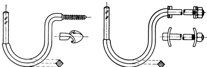
Abb. 150. Gebogene Stützen, genormt nach DIN VDE 8041.
