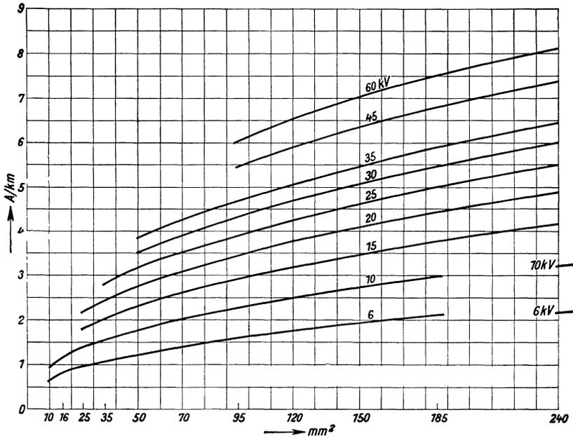
Abb. 340. Erdschlußstrom von H- und Einleiterkabeln.
