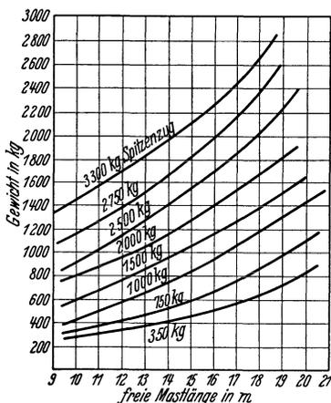
Abb. 282. Gewichte von Stahlgittermasten mit Betonfundament bei verschiedenen Spitzenzügen.
