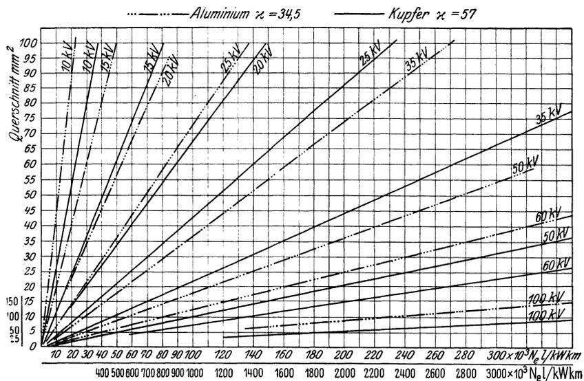
Abb. 95. Kennlinien für die Querschnittsermittlung bei Drehstrom-Freileitungen und verschiedenen Spannungen in Abhängigkeit von den kWhm der Strecke (Leistungsverlust 10 vH).
