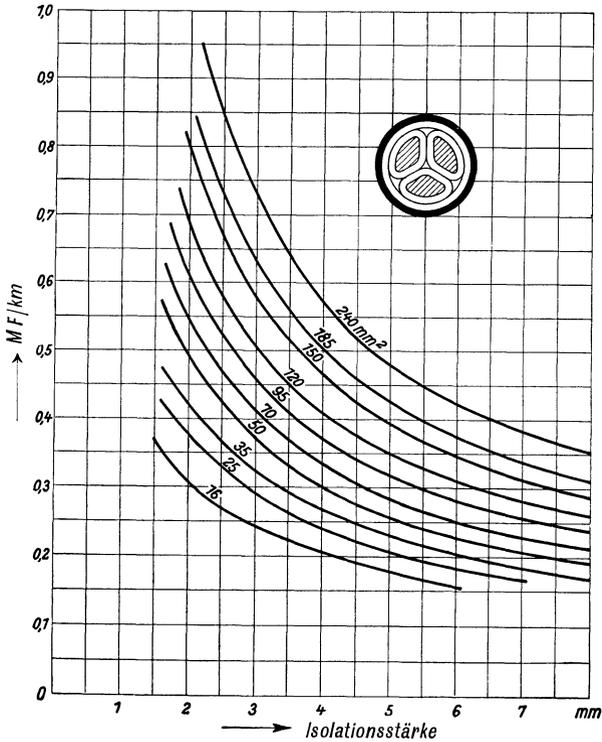
Abb. 346. Meßkapazität von Dreileiterkabeln mit Gürtelisolierung und Sektorleitern in der Schaltung: Ein Leiter gegen die beiden anderen und Bleimantel ( $c_{10} + 2 c_{12}$ ).
