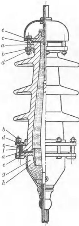
Abb. 381. Kittloser Kabelendverschluß mit Ausdehnungsraum der Rhein. Draht- und Kabelwerke, Köln-Riehl. (Erläuterung siehe Text.)
