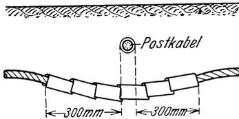
Abb. 355. Kreuzung zwischen Postkabel und Hochspannungskabel, Schutzabdeckung.
