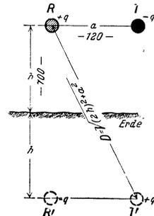
Abb. 66. Beispiel für die Kapazitätsberechnung einer Einphasenleitung.
