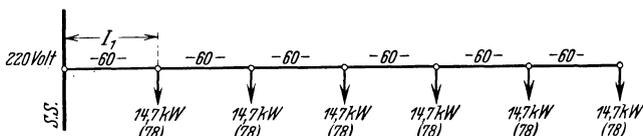
Abb. 8. Offene Gleichstromleitung mit gleichmäßig verteilter Belastung.
