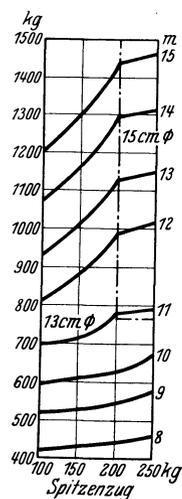
Abb. 283. Gewichte und Preise von Schleuderbeton-Leichtmasten.
