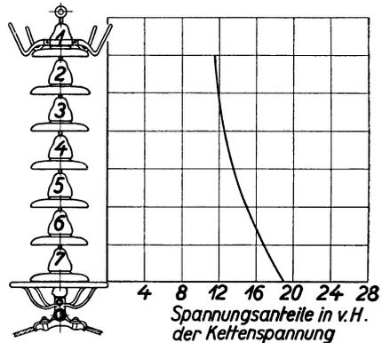
Abb. 167. Spannungsüberschlag an einer 7-gliedrigen Kette aus Kappenisolatoren (mit Schutzvorrichtungen).
