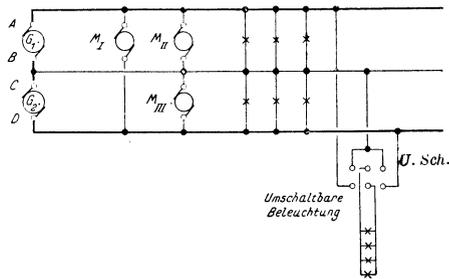
Abb. 21. Verteilung von Licht- und Kraftanschlüssen auf ein Dreileiternetz.
