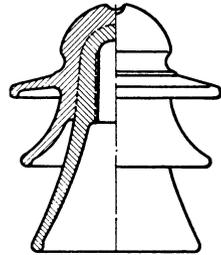
Abb. 146. Genormter Delta-Stützenisolator (volle Linien = einteilig, gestrichelte Linie = zweiseitig).
