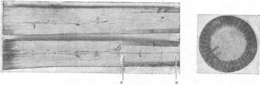
Abb. 197. Schnitte durch einen nach dem Cobra-Verfahren imprägnierten Mastfuß.
