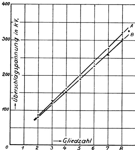
Abb. 161. Regen-Überschlagspannung bei wagerechter Aufhängung: Kennlinie A = Kette aus Abspannisolatoren nach Abb. 160, Kennlinie B = Kette aus Hängeisolatoren nach Abb. 159 (Leitfähigkeit des Regens  $\lambda = 250 \mu S \text{ cm}^{-1}$ ).
