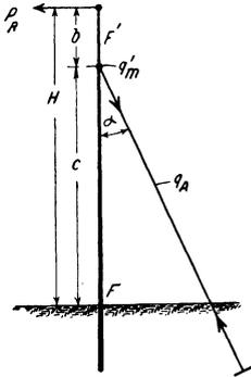
Abb. 252. Mast mit Zuganker.
