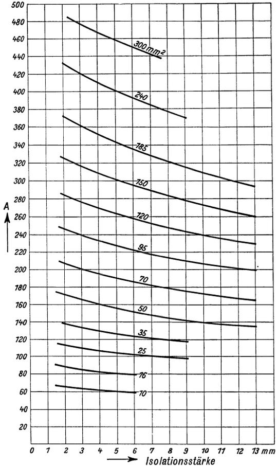
Abb. 328. Dauernd zulässige Stromstärken bei Dreileiterkabeln mit Gürtelisololation bei Verlegung im Erdboden.
