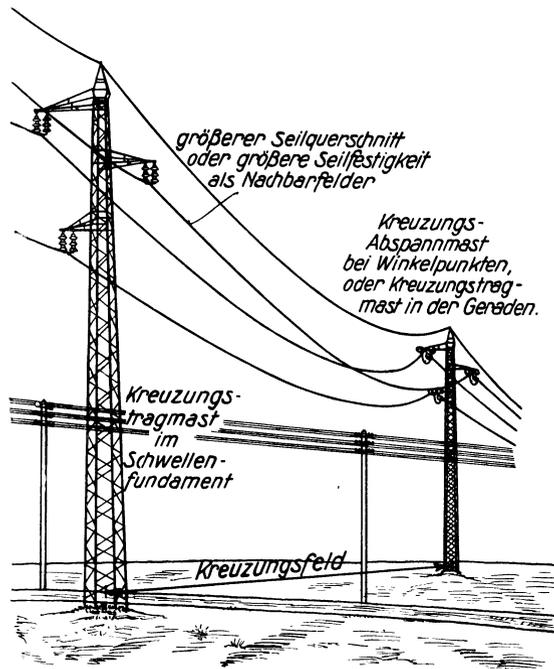
Abb. 272. Besondere Ausführung einer Straßen- und Postleitungskreuzung mit Abspann- und Kreuzungstragmast.
