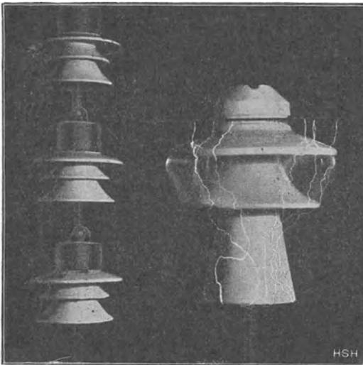
Abb. 155. Hängeisolator und Stützenisolator unter gleicher Spannung.
