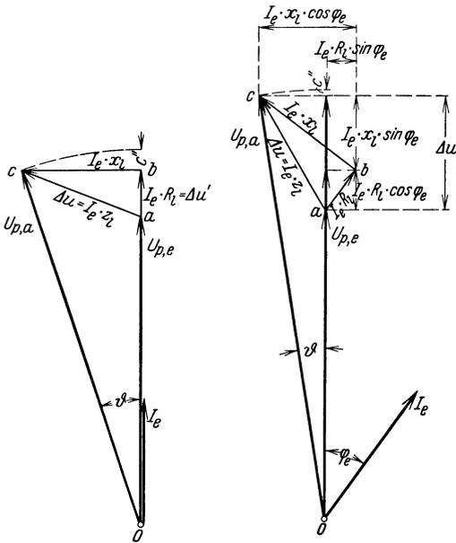
Abb. 93. Induktionsfreie Belastung.
