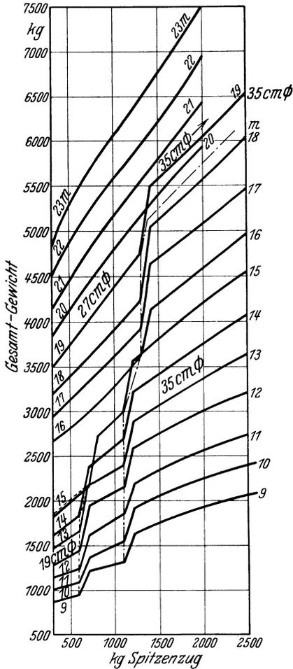
Abb. 285. Gewichte von Schleuderbetonmasten bei verschiedenen Mastlängen und Spitzenzügen.
