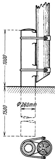
Abb. 200. Betonstempel als Mastfuß.
