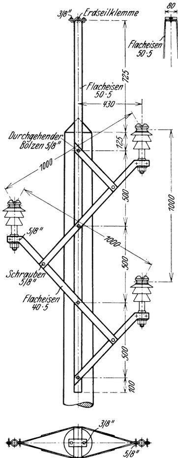
Abb. 212. Isolatorträger in Vogelschutzdurchbildung für Stützenisolatoren an Holzmasten und Erdseilbefestigung.
