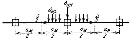
Abb. 242. Windbelastung auf Leiter und Mast senkrecht zur Leitungsrichtung.
