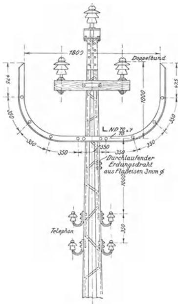
Abb. 267. Mast mit Träger für ein Schutznetz.
