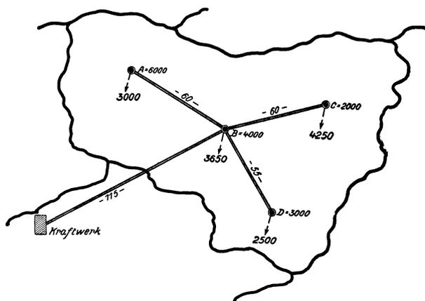
Abb. 97. Kraftwerk mit Doppelleitung, Abnahmestellen in Radialanordnung mit Hauptverteilungsstelle verbunden.
