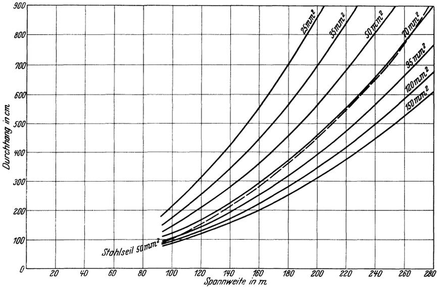
Abb. 135. Durchhang von Aldreyseilen  $\sigma_{\max} = 12 \text{ kg/mm}^2$ , Stahlseil wie in Abb. 134 (siehe Bemerkungen Abb. 134).
