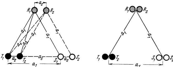
Abb. 58 u. 59. Drehstrom-Einfachleitung mit je 2 Leitern f. j. Phase, symmetrische Anordnung.
