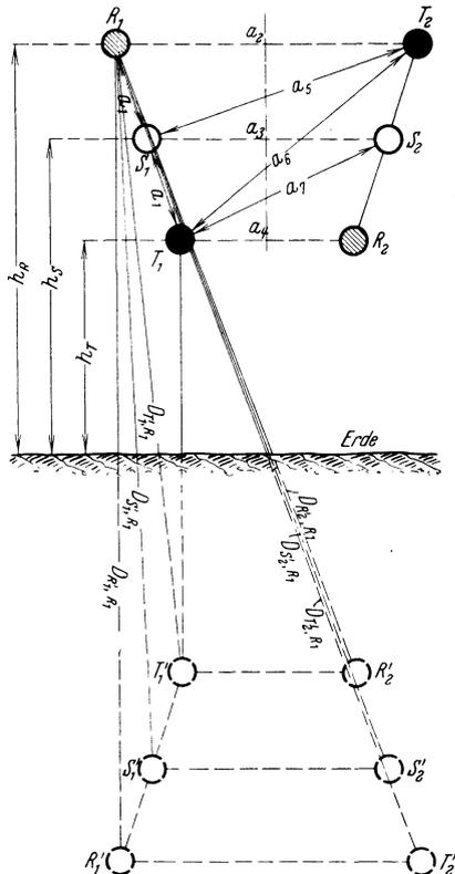
Abb. 73. Kapazitätsberechnung für die Drehstrom-Doppelleitung (umgekehrte Tannenbaumform).
