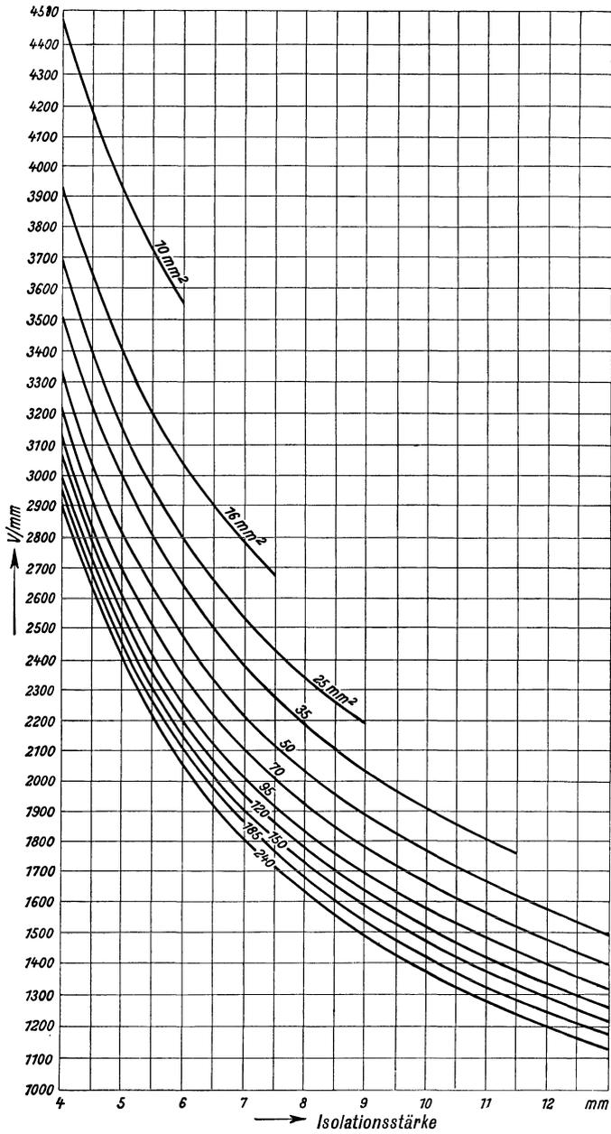
Abb. 325. Höchstbeanspruchung zwischen Leiter und Bleimantel bei Dreileiterkabeln mit Gürtelisolierung für eine Spannung von 10000 V eff.
