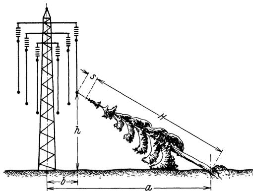
Abb. 276. Berechnung der Durchhiebbreite bei Waldschneisen.
