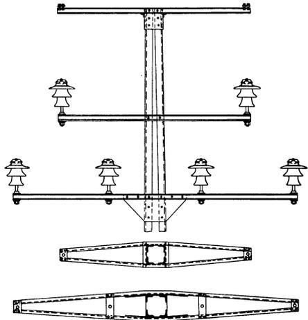
Abb. 226. Querträger für Stützenisolatoren bei Stahlgittermasten.
