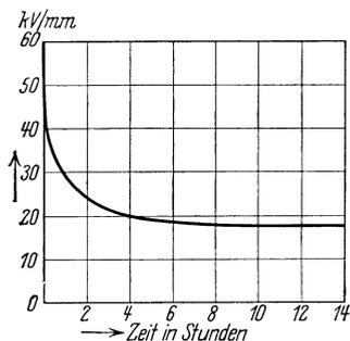
Abb. 327. Durchschlagsfestigkeit in Abhängigkeit von der Zeit (Zeitdurchschlagskennlinie).
