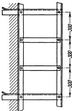
Abb. 366. Kabelbrücke für Wandverlegung.
