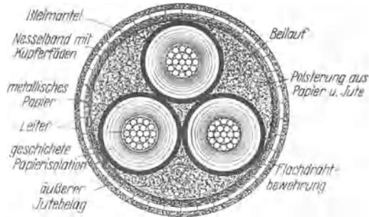
Abb. 300. Verseiltes Drei-Einleiterkabel (Dreimantelkabel) mit Metallisierung, runde Form (NKFA).
