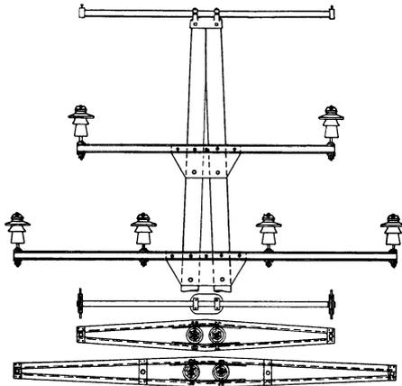
Abb. 211. U-Eisenträger für Stützenisolatoren an A-Holzmasten und Erdseilträger für 2 Seile.
