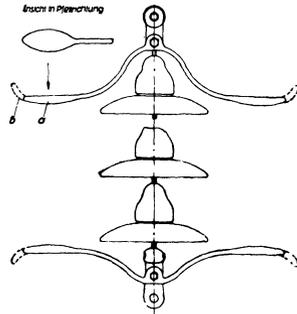
Abb. 178. Richtige Formgebung der einfachen Schutzhörner unten und oben an einer Hängekette.
