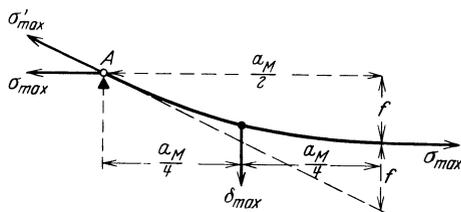
Abb. 119. Zugspannung am Leiteraufhängepunkt.
