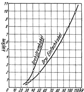
Abb. 336. Dielektrische Verluste bei einem Dreileiter- und 3 Einleiterkabeln für verschiedene Spannungen.
