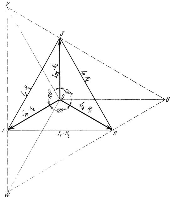
Abb. 32. Spannungsdiagramm für eine Drehstromanlage in Dreieckschaltung (gleiche Phasenbelastung).
