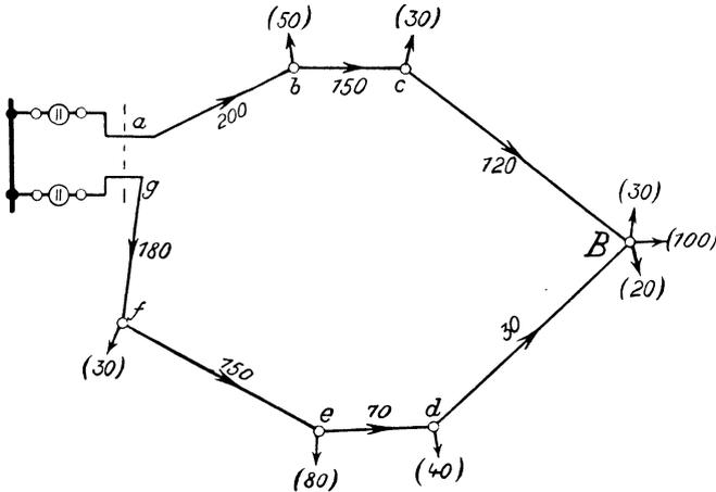
Abb. 16. Äußerer Ring des vermaschten Netzes der Abb. 15.
