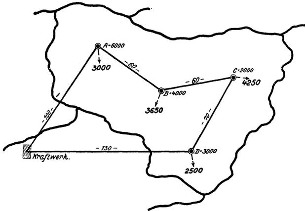
Abb. 96. Ringleitung zwischen Kraftwerk und Hauptabnahmestellen.
