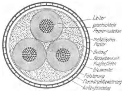
Abb. 297. Glimm- und strahlungsfreies Dreileiterkabel (H-Kabel) (NKFA).
