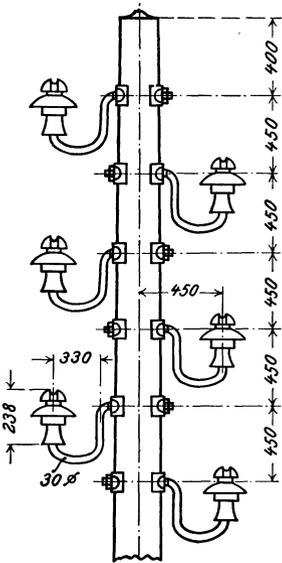
Abb. 206a. Isolatorbefestigung mit durchgehendem Bolzen an Holzmasten: 6 Leiter von je  $50 \text{ mm}^2$ .
