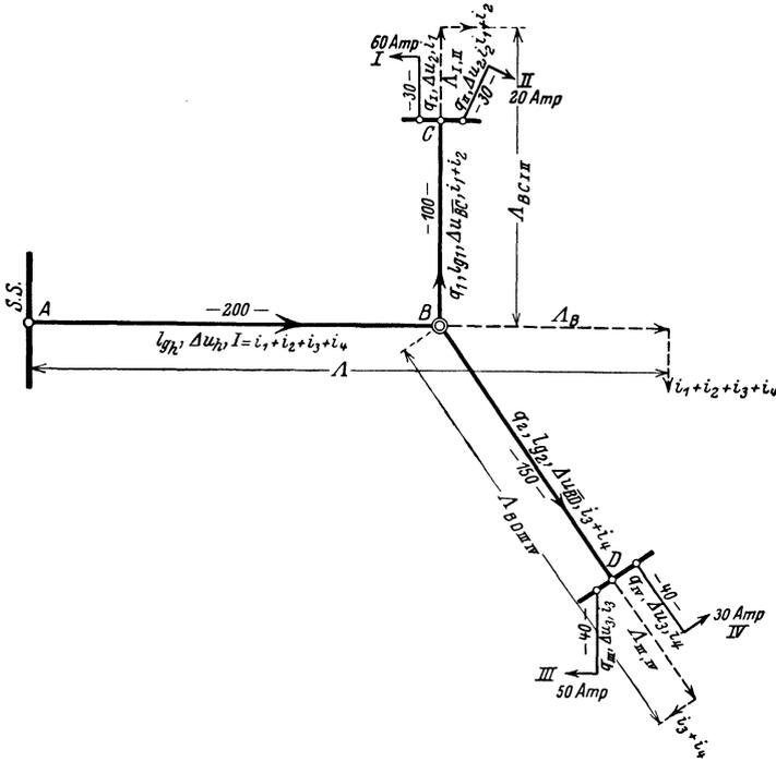
Abb. 10. Beispiel für die Berechnung eines verzweigten Leitungsnetzes.
