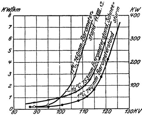
Abb. 88. Koronaverlustkennlinien der Lauchhammer-Freileitung.
