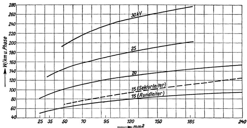
Abb. 333. Dielektrische Verluste je Phase von Dreileiterkabeln mit Gürtelisolierung bei Betriebsspannung  $U$ .
