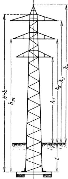
Abb. 244. Stahlgittermast mit Schwellenfundierung.
