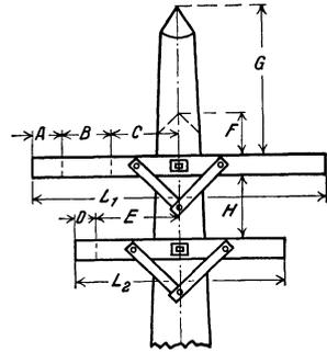
Abb. 207. Holzquerträger für Isolatorenbefestigung an Holzmasten.
