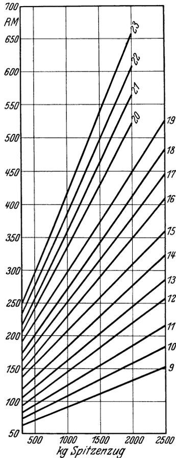
Abb. 286. Preise von Schleuderbetonmasten nach Abb. 285.
