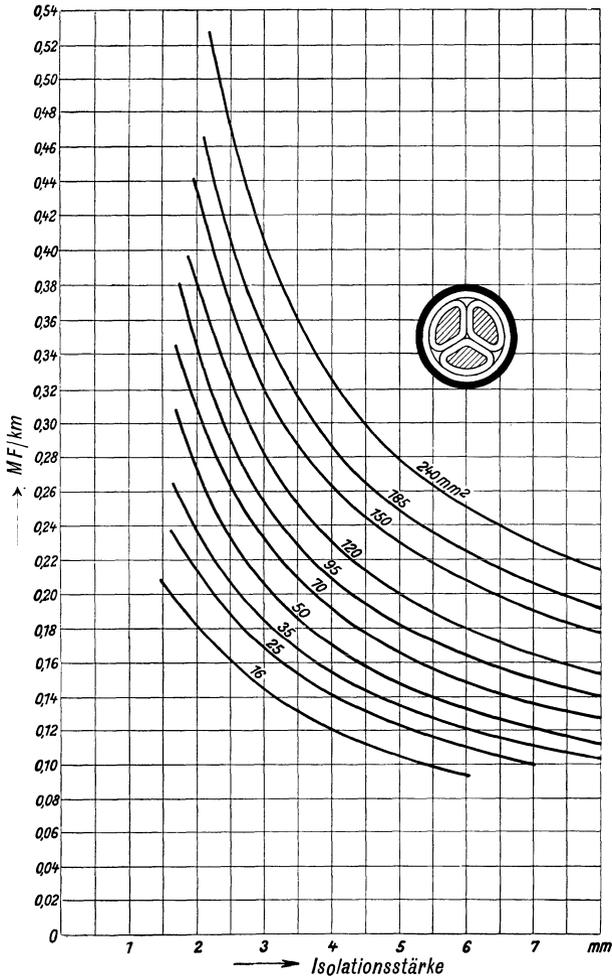
Abb. 342. Betriebskapazität  $C_0$  je Phase von Dreileiterkabeln mit Gürtelisolation und Sektorleitern.
