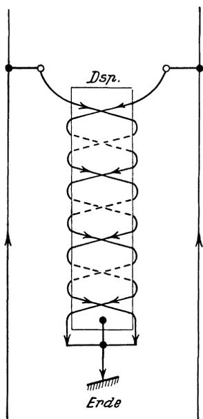
Abb. 290. Erdungsdrosselspule in einer Fernsprechleitung.
