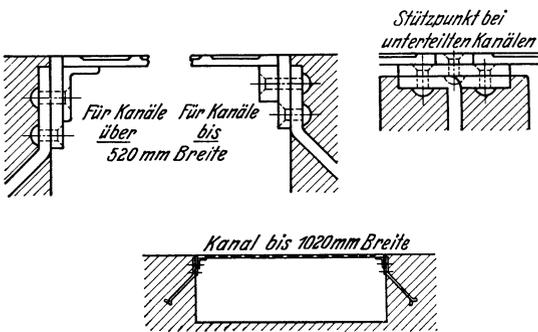
Abb. 362. Kanal mit Riffelblechabdeckung und Baueinheiten.
