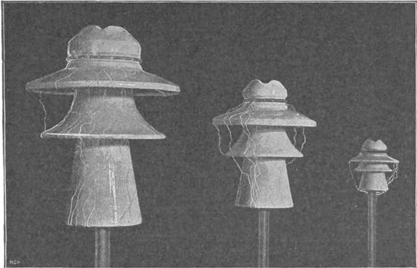
Abb. 147. Gleitfunkenbildung an drei verschieden hohen Stützenisolatoren.
