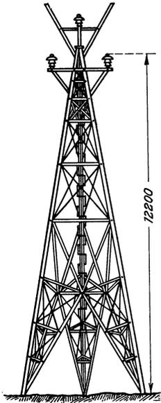
Abb. 224. Dreifußförmiger Stahlgittermast amerikanischer Bauart, 2 Erdseile.
