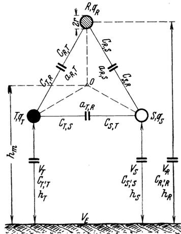
Abb. 70. Kapazitätsberechnung einer Drehstromleitung.
