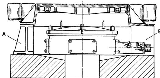
Abb. 391. Kabelkasten mit Brunnenrahmen für Einbau in Straßendamm.
