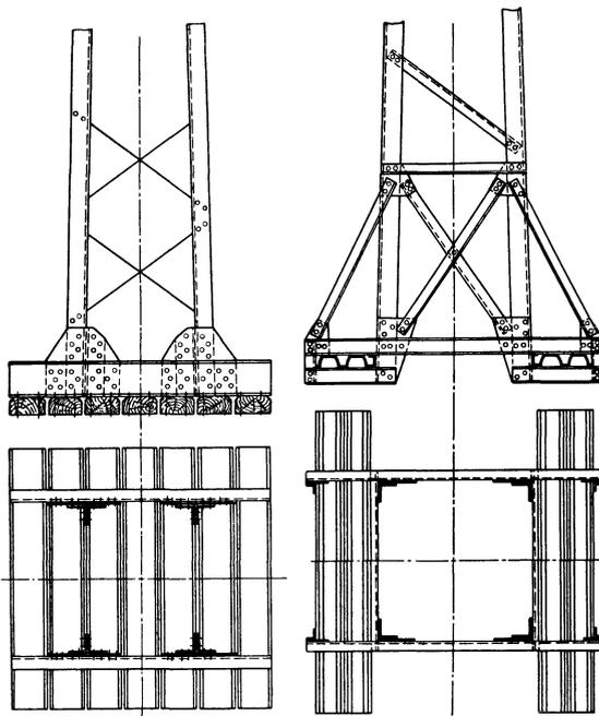
Abb. 235. Verschiedene Ausführung von Schwellen- oder Plattenfundamenten bei Stahlgittermasten.
