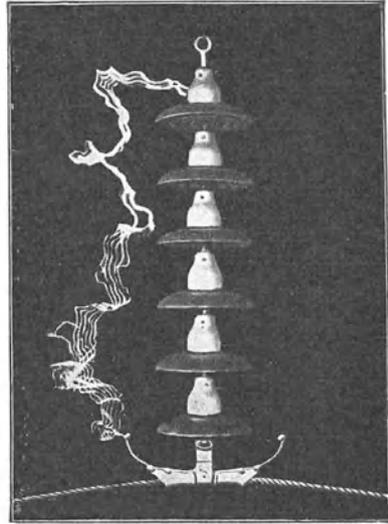
Abb. 174. Mit Schutzvorrichtung am untersten Isolator.
