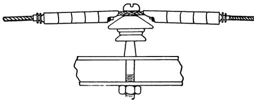
Abb. 228. Vogelschutzrohre bei Stützenisolatoren.
