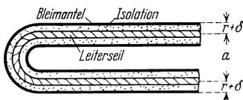
Abb. 329. Bleimantelverlustermittlung für zwei parallele Einleiterkabel.
