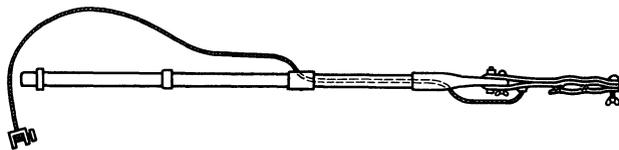
Abb. 278. Erdungs- und Kurzschlußstange D. R. P. 447 411.
