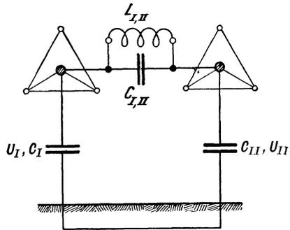
Abb. 79. Drosselspulschaltung bei Drehstrom-Doppelleitungen für Milderung der Spannungsübertragung.
