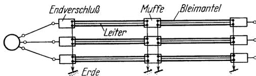
Abb. 331. Bleimantelerdung bei Einleiterkabeln in Drehstromanlagen.
