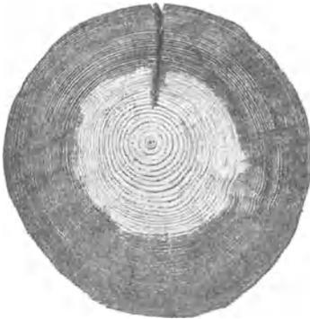
Abb. 195. Mastschnitt durch eine teerölimprägnierte Kiefer.
