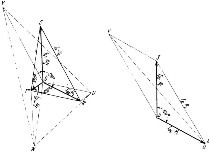
Abb. 33 u. 34. Spannungsdiagramm für eine ungleich belastete Drehstromanlage in Dreieck-Dreieckschaltung. (Alle drei Phasen ungleich belastet.) (Zwei Phasen unbelastet, die dritte voll belastet.)
