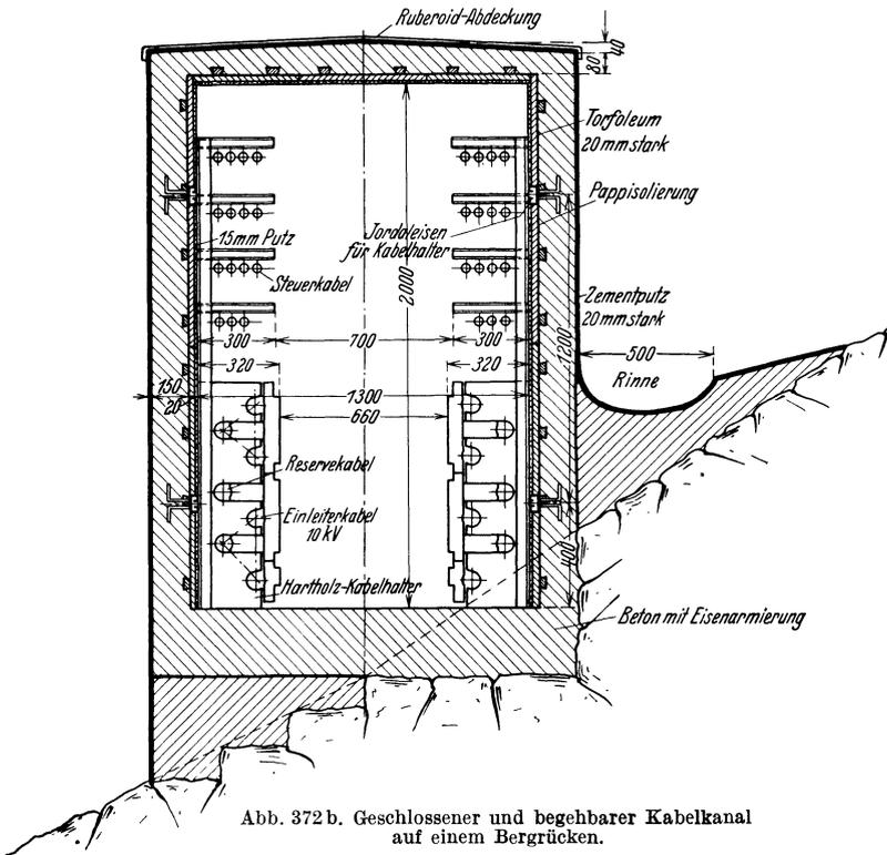
Abb. 372b. Geschlossener und begehbare Kabelkanal auf einem Bergrücken.
