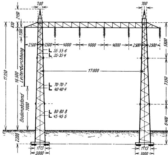
Abb. 234. Portalmast für eine 100 kV-Drehstrom-Doppelleitung, 2 Erdseile, Schwellenfundierung.
