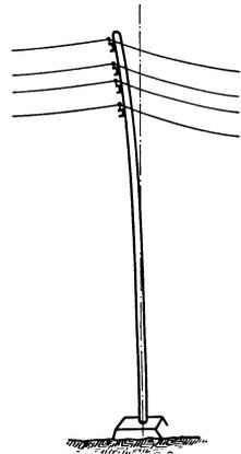
Abb. 222. Durchfederung eines U-Eisenmastes bei Seilriß.
