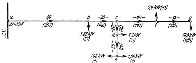
Abb. 7. Beispiel für die Berechnung einer mehrfach belasteten, offenen Gleichstromleitung.
