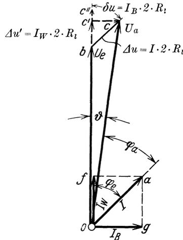
Abb. 24. Induktive Belastung.
