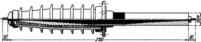
Abb. 191. Hartpapierdurchführung für 100 kV mit Porzellanüberwurf.
