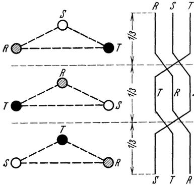
Abb. 54. Verdrillungsplan für eine einfache, unsymmetrische Drehstromleitung.
