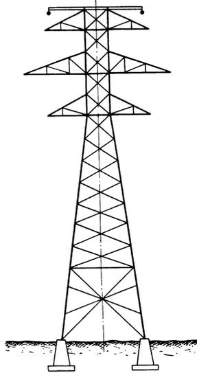
Abb. 225. Stahlgittermast mit aufgelöster Fundierung.
