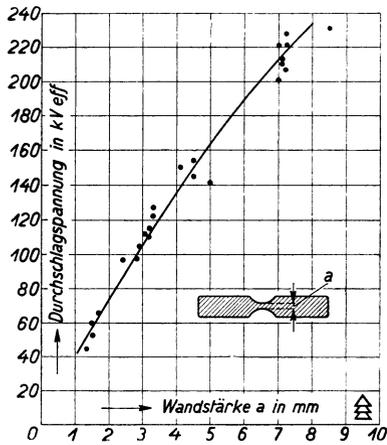
Abb. 138. Verlauf der Durchschlagsfestigkeit bei Porzellanplatten.
