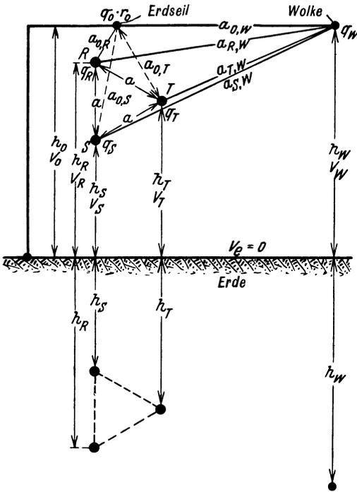
Abb. 74. Potentialverteilung bei einer Drehstrom-Einfachleitung mit Erdseil und Wolkenähe.
