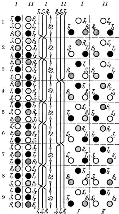
Abb. 56. Günstigster Verdrehungsplan für eine Drehstrom-Doppelleitung.
