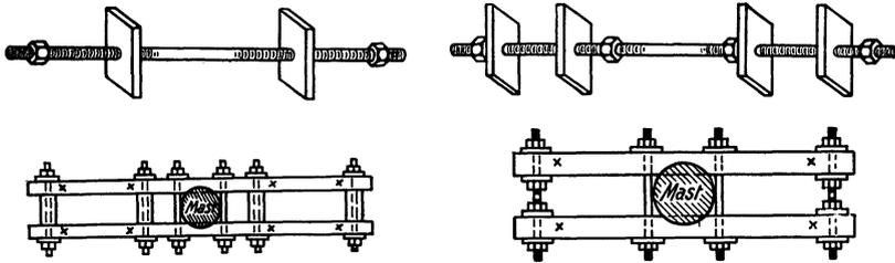
Abb. 208 u. 209. Holzquerträger für Isolatoren an Holzmasten (doppelt) mit Befestigungsbolzen.
