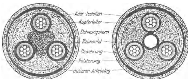
Abb. 319. Dehnungskabel der Hackethal-Draht- und Kabelwerke.
