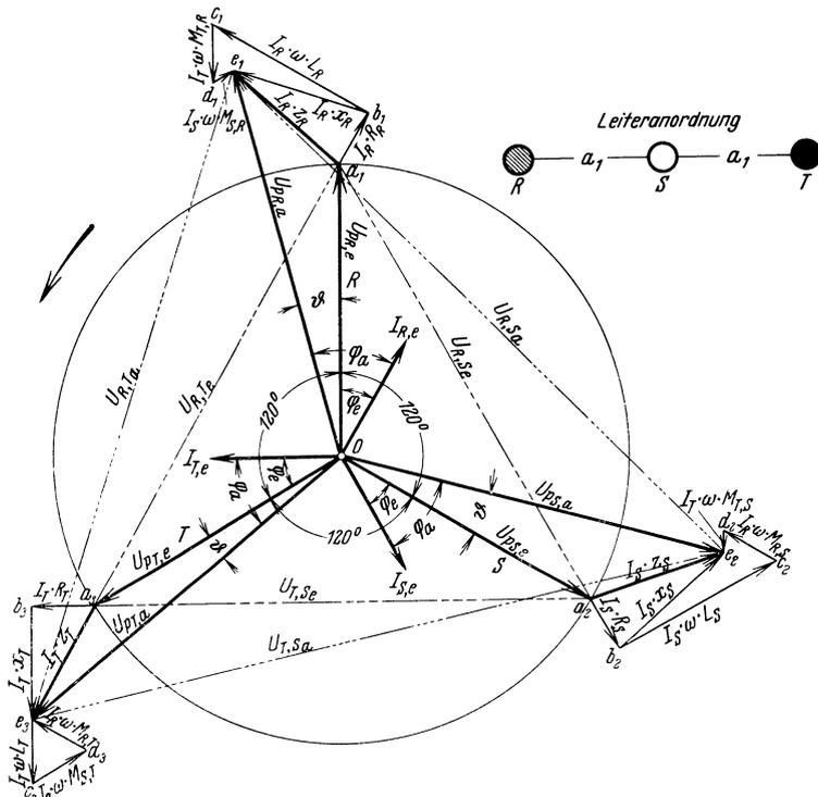
Abb. 61. Spannungsdiagramm für eine Drehstromleitung mit Ohmschem Widerstand und Selbstinduktion (unsymmetrische unverdrillte Leiteranordnung).
