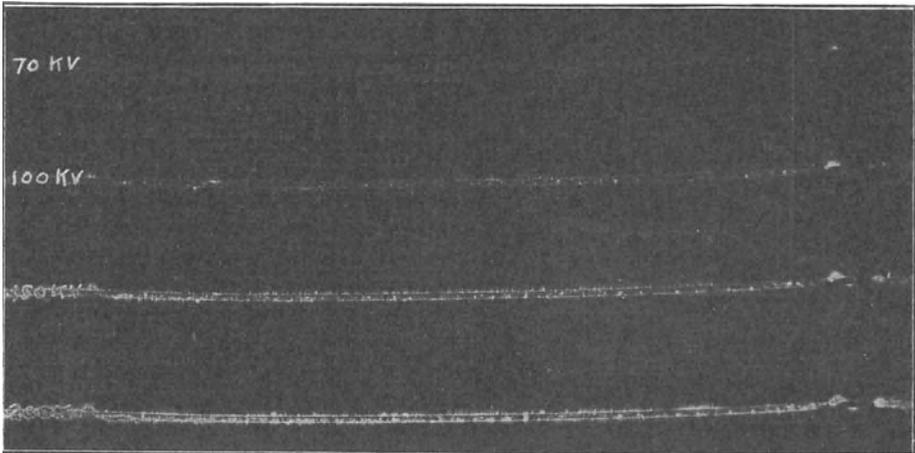
Abb. 85. Leuchten von Drähten bei 70 bis 200 kV (Strahlungserscheinungen, Korona).
