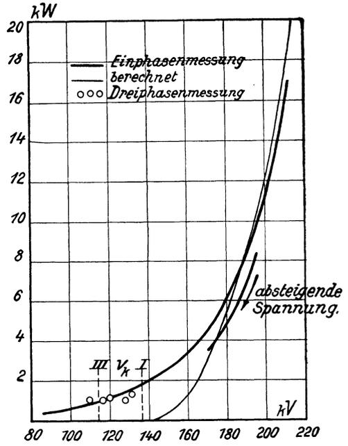
Abb. 89. Koronaverluste der 100 kV-Leitung Goldenberg-Werk-Osterath.
