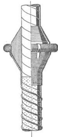
Abb. 377. Endausbildung der Metallisierung eines Kabels für Einführung in einen Endverschluß.
