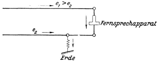
Abb. 288. Störungsstrom im Fernsprechnet.
