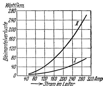
Abb. 303. Bleimantelverluste bei Drei-Einleiterkabeln, 35 kV:
