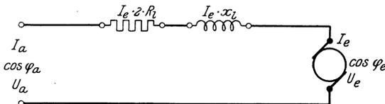
Abb. 49. Einphasenleitung mit Ohmschem Widerstand und Selbstinduktion.
