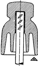
Abb. 145. Stützenisolator für Niederspannung.
