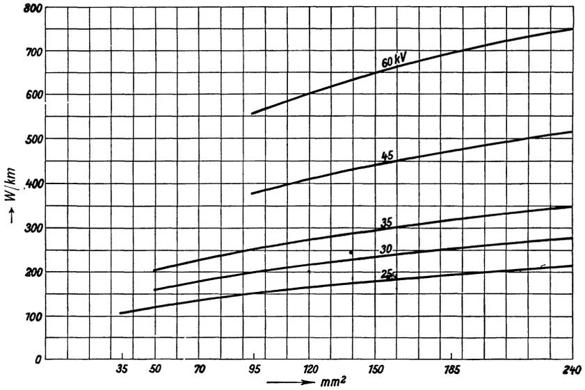
Abb. 334. Dielektrische Verluste je Phase von H-Kabeln bei Betriebsspannung  $U$ .
