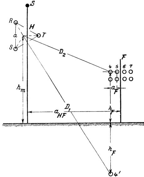
Abb. 103. Elektrostatische Beeinflussung einer Schwachstromleitung durch eine Drehstromleitung.
