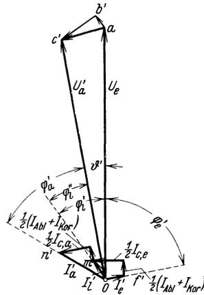
Abb. 92. Spannungs- und Stromdiagramm zu Abb. 90. Leerlauf der Leitung.
