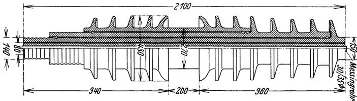
Abb. 190. Mehrrohrdurchführung für 100 kV.
