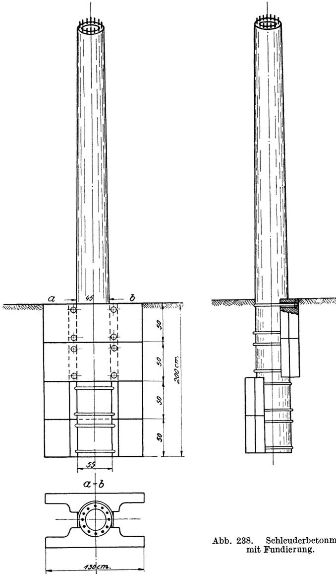
Abb. 238. Schleuderbetonmast mit Fundierung.
