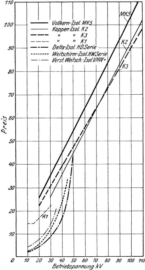
Abb. 152. Preisvergleich für Stützen- und Kettenisolatoren.
