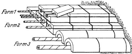
Abb. 358. Verschiedene Formen von Kabelschutzsteinen.
