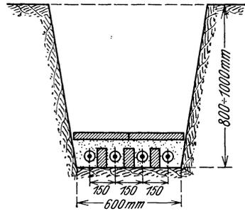
Abb. 354. Querschnitt durch einen Kabelgraben für Hochspannungskabel.
