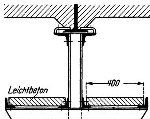
Abb. 367. Doppelbrücke für Kabelverlegung an der Decke.
