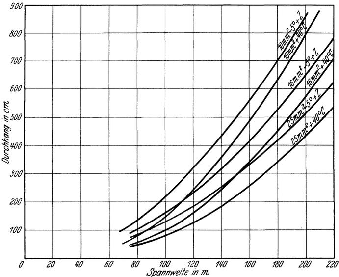
Abb. 136. Durchhang von Kupferpanzerstahlseilen  $\sigma_{\max} = 26 \text{ kg/mm}^2$ . (Durchhangskennlinien für + 40° C und – 5° C + VSF-Zusatzlast.)
