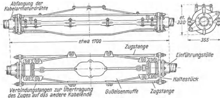
Abb. 387. Muffe für besondere Zugbeanspruchung.
