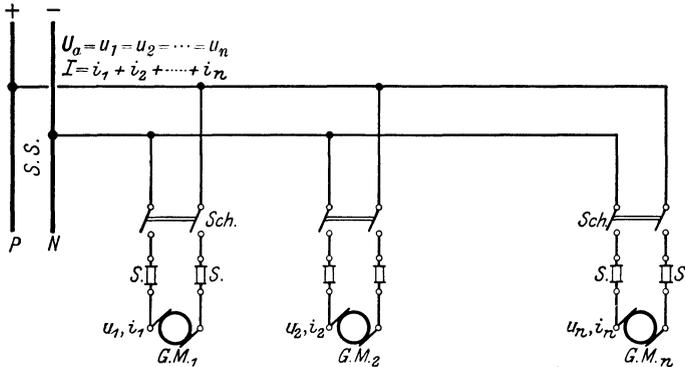
Abb. 2. Parallelschaltung der Stromverbraucher.
