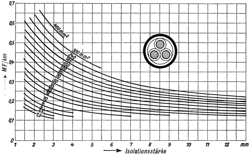
Abb. 345. Meßkapazität von Dreileiterkabeln mit Gürtelisolierung und runden Leitern in der Schaltung: Ein Leiter gegen die beiden anderen und Bleimantel ( $c_{10} + 2 c_{12}$ ).
