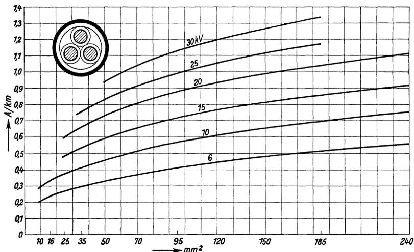
Abb. 347. Ladestrom je Phase bei Betriebsspannung  $U$  von Dreileiterkabeln mit Gürtel-isolation und runden Leitern.
