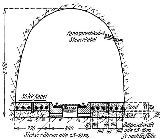
Abb. 371. Befahrbarer Kabelstollen der Oberhasli-Werke für 50-kV-Einleiterkabel.
