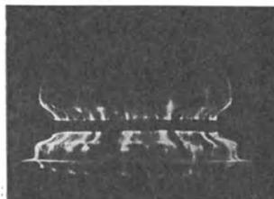
Abb. 139. Glimm- und Büschelentladungen an einem Stützenisolator in trockener Luft.
