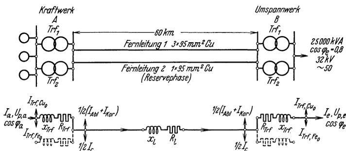
Abb. 98 und 99. Schalt- und Ersatzschaltbild zum 24. Beispiel.
