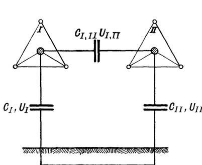
Abb. 78. Spannungsübertragung bei einer Doppelleitung (einfache Darstellung).
