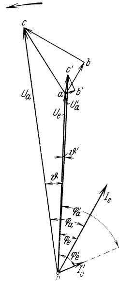
Abb. 62. Spannungsdiagramm für:
