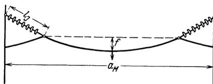
Abb. 120. Leiteraufhängung an schweren Abspannkettenspannkettenisolatoren.
