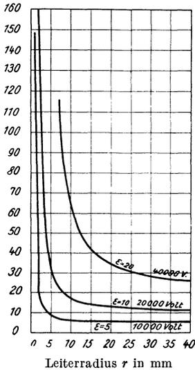
Abb. 322. Isolationsstärke in Abhängigkeit vom Leiterradius für verschiedene Werte von  $\epsilon$ .
