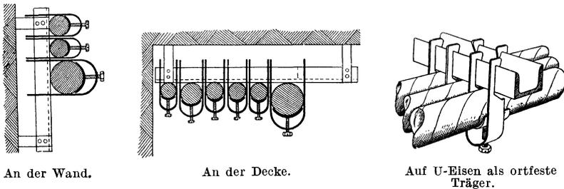
Abb. 370. Kabelschnellverleger für verschiedene Kabellagen und Kabeldurchmesser.
