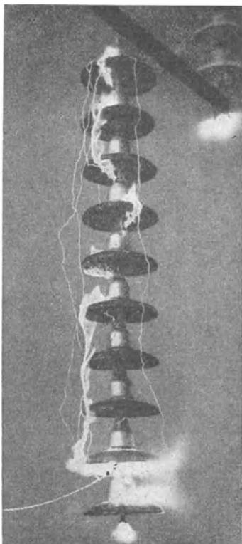
Abb. 164. Spannungsüberschlag an einer 6gliedrigen Hängekette in trockener Luft bei 490 kV.
