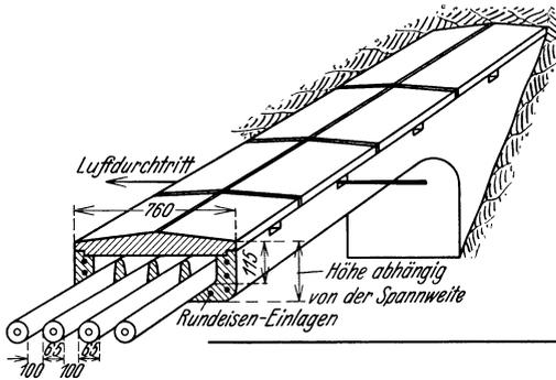
Abb. 361. Kabelkanalbrücke aus Beton.
