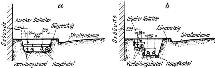
Abb. 353. Kabelverlegung unter dem Bürgersteig (a nebeneinander, b nach der Tiefe verteilt).
