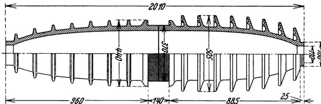
Abb. 187. Einfache Massedurchführung für 100 kV.
