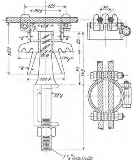
Abb. 263. Klemmverbindung für zwei Leiter auf einem Isolator.
