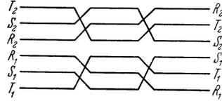
Abb. 55. Einfacher Verdrehungsplan für eine Drehstrom-Doppelleitung.
