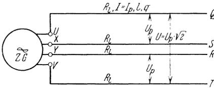
Abb. 28. Unverketteter Zweiphasen-Wechselstromkreis.
