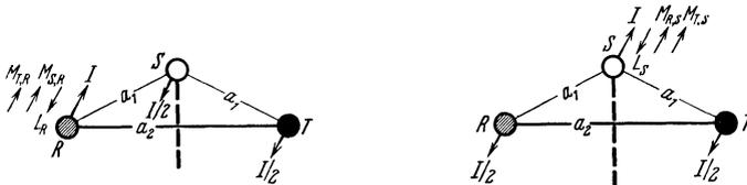
Abb. 52. Einfache Drehstromleitung; unsymmetrische Anordnung.
