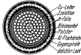
Abb. 372a. Kabelquerschnitt.
