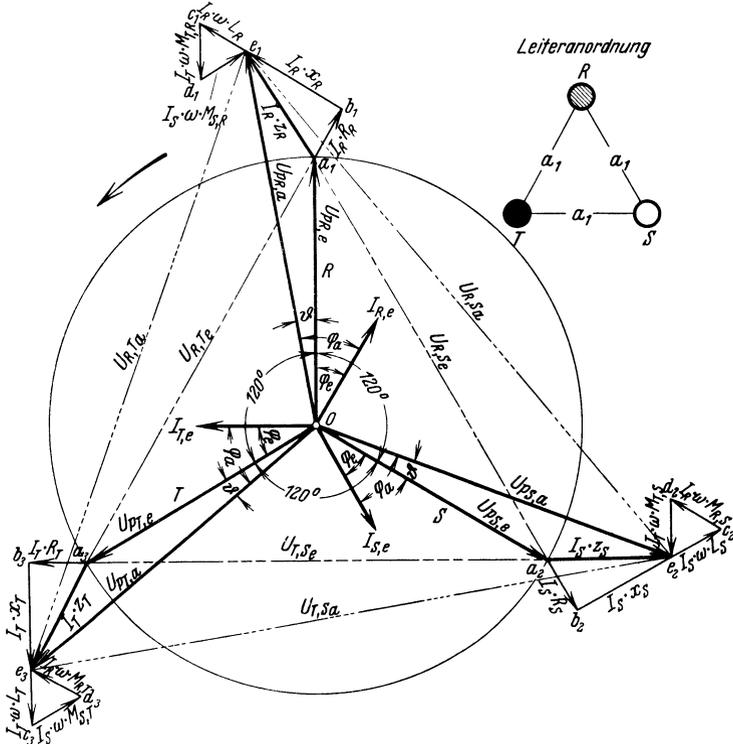
Abb. 60. Spannungsdiagramm für eine Drehstromleitung mit Ohmschem Widerstand und Selbstinduktion (symmetrische Leiteranordnung).
