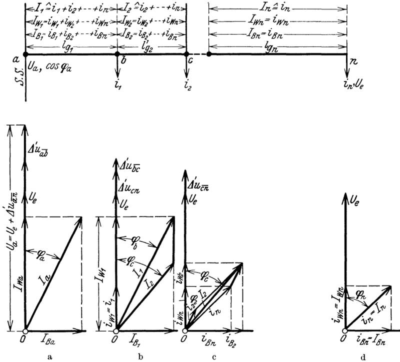
Abb. 25. Vektorielle Berechnung einer mehrfach belasteten Wechselstrom-Einphasenleitung.
