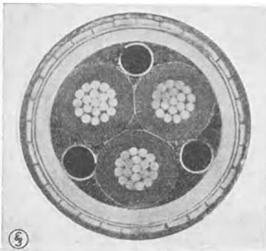
Abb. 305. Querschnitt eines Drehstrom-Ölkabels,  $3 \times 95 \text{ mm}^2 \text{ Cu}$ , 30 kV (SSW).
