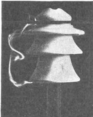
Abb. 141. Spannungsüberschlag an einem Stützenisolator in trockener Luft.
