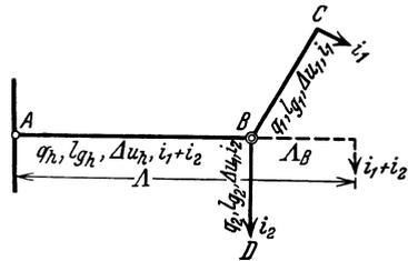
Abb. 9. Verzweigtes Leitungsnetz.
