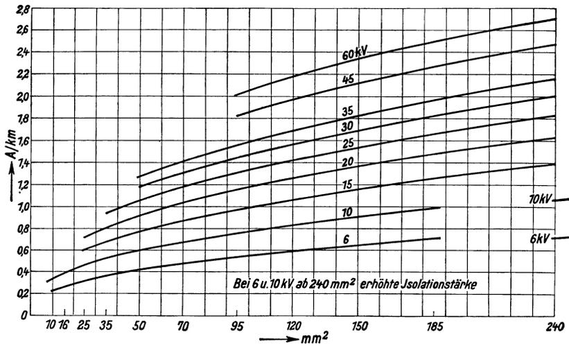
Abb. 339. Ladestrom von H- und Einleiterkabeln bei Betriebsspannung  $U$ .
