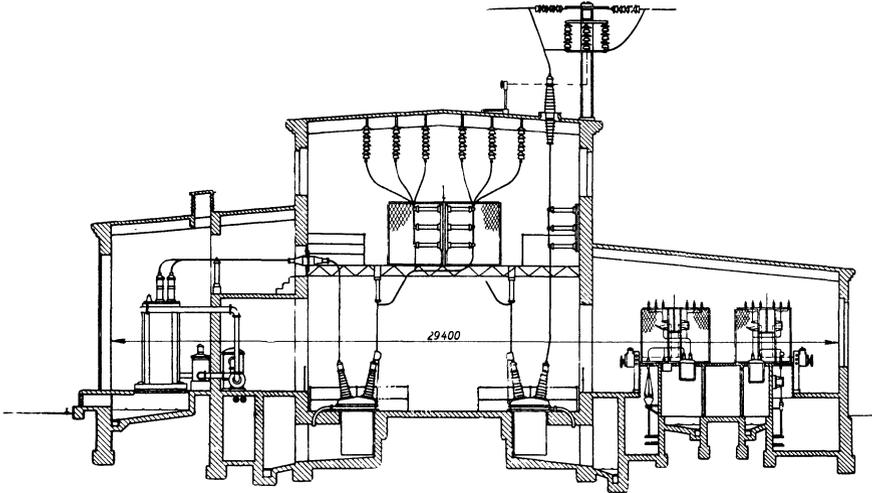
Abb. 189. Dacheinführung der Freileitungen in ein Umspannwerk (BBC).
