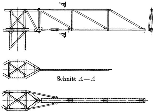
Abb. 231. Schwenkträger für Kettenisolatoren (Bauart BBC).
