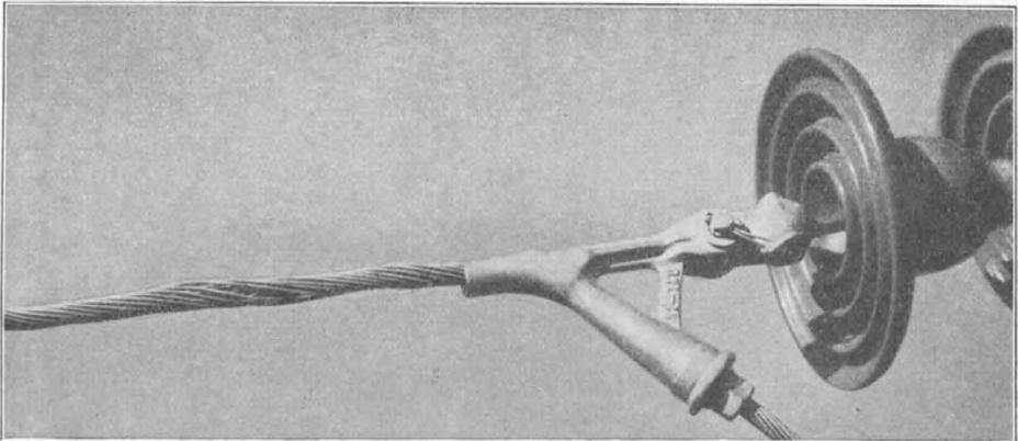
Abb. 113. Korbbildung an einem Freileitungsseil.
