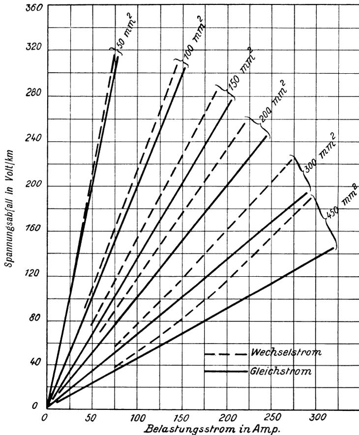
Abb. 43. Spannungsabfall in Stahlseilen bei Gleichstrom und Wechselstrom,  $f = 50$  Hertz.
