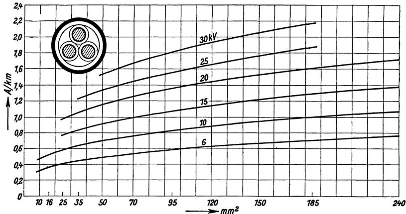
Abb. 349. Erdschlußstrom von Dreileiterkabeln mit Gürtelisolierung und runden Leitern.
