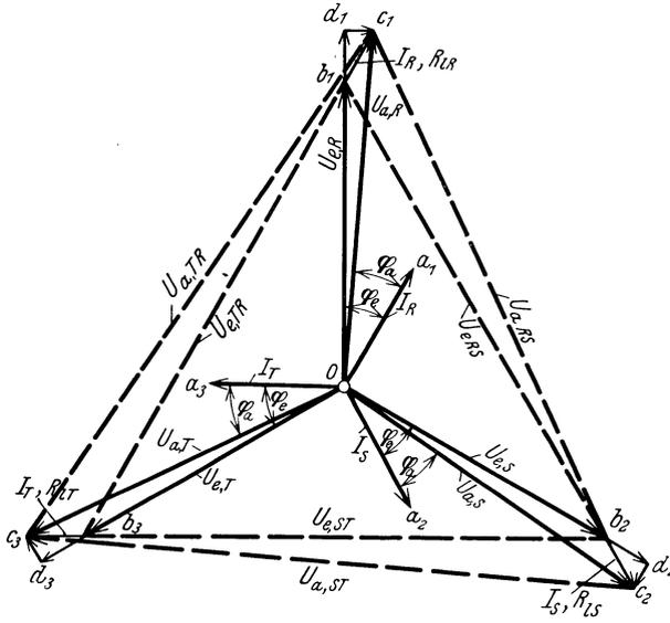
Abb. 30. Vektordiagramm für eine Drehstromleitung.
