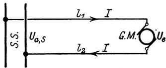
Abb. 4. Offene Gleichstromleitung (zweipolig gezeichnet).
