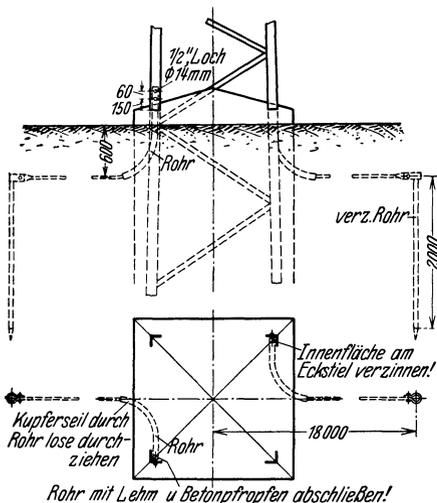
Abb. 277. Anschluß und Ausführung der Rohrbänderung an Maste mit Betonklotzfundament.
