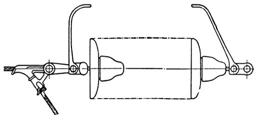
Abb. 180. Halbhörner (Hofmann, Kötzschenbroda) an einer Abspannkette.
