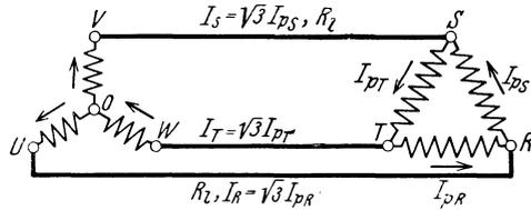
Abb. 40. Dreiphasenanlage (Stern-Dreieckschaltung.)
