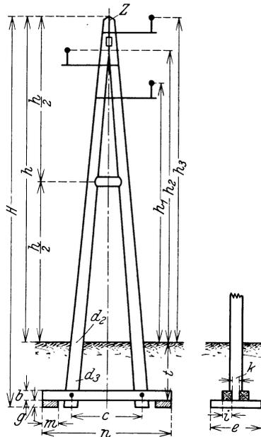
Abb. 251b. A-Holzmast mit Schwellenfundierung.
