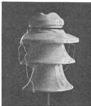
Abb. 140. Gleitfunken an einem Stützenisolator in trockener Luft.
