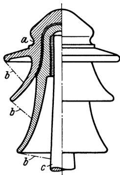
Abb. 142. Überschlagweg an einem Stützenisolator unter  $45^\circ$  Regeneinfall.
