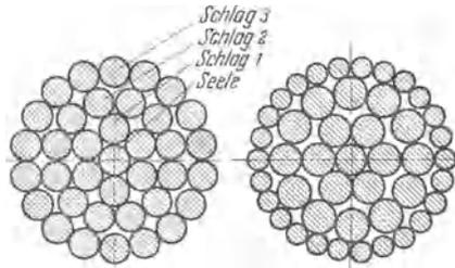
Abb. 114. Gewöhnlicher dreischlägiger Aufbau von Leiterseilen.  $1 + 6 + 12 + 18 = 37$  Drähte.
