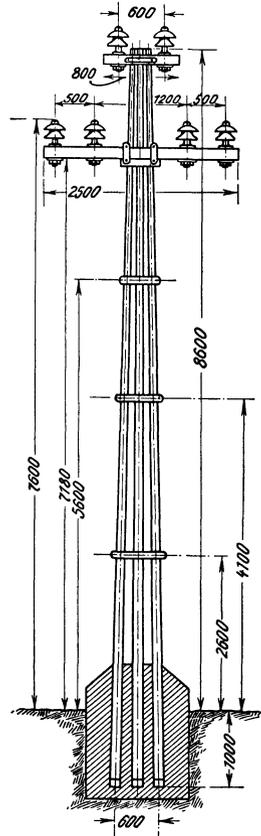
Abb. 219. Aus 3 Mannesmann-Röhren zusammengesetzter A-Mast (Gebirgsstrecken Caffaro-Brescia, Oerlikon) für eine 46 kV-Drehstromleitung.
