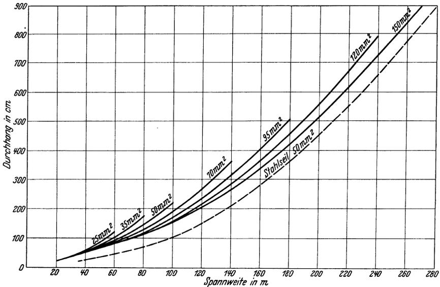
Abb. 134. Durchhang von Aluminiumseilen  $\sigma_{\max} = 8 \text{ kg/mm}^2$ , Stahlseil  $50 \text{ mm}^2$ ,  $\sigma_B = 70 \text{ kg/mm}^2$ ,  $\sigma_{\max} = 26 \text{ kg/mm}^2$ . (Stärkster Durchhang stets bei  $+40^{\circ}\text{C}$ , Höchstzugspannungen teils  $-5^{\circ}\text{C}$  + VSF-Zusatzlast, teils bei  $-20^{\circ}\text{C}$  ohne Zusatzlast.)
