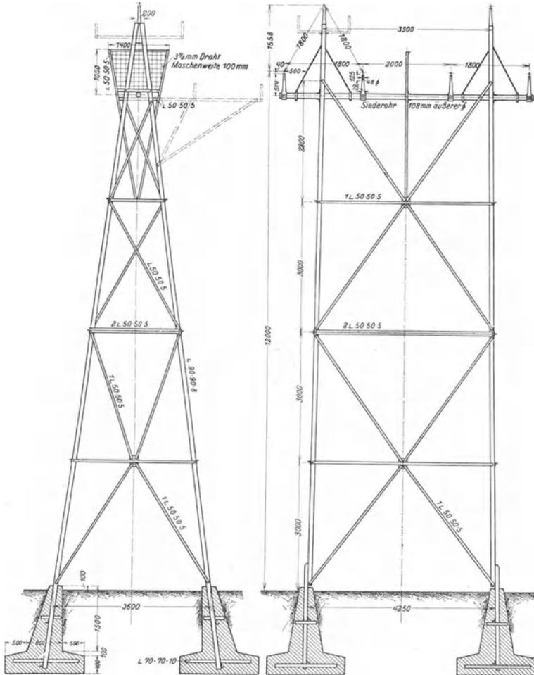
Abb. 257. Eisenmast für zwei durch Schutzgitter getrennte Drehstromleitungen.
