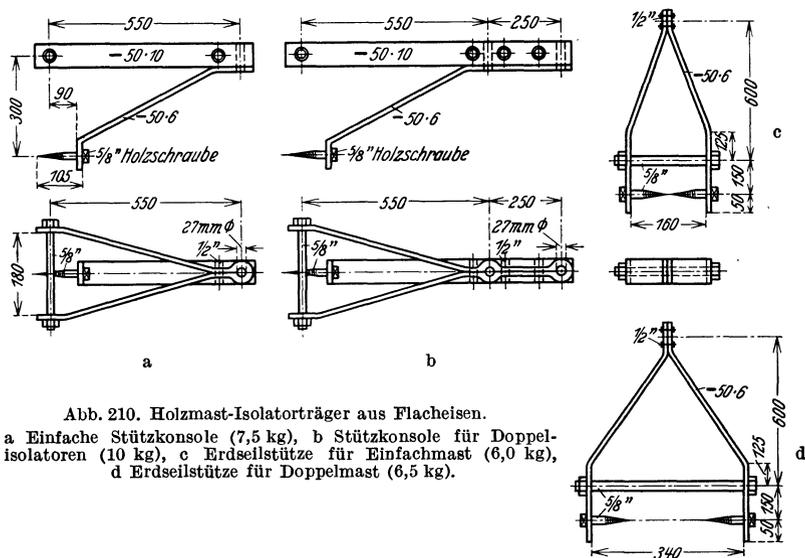
Abb. 210. Holzmast-Isolatorträger aus Flacheisen.
