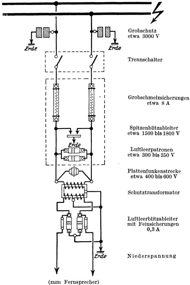
Abb. 105. Hochspannungsschutz für Fernsprechanlagen der S. & H. A.-G.
