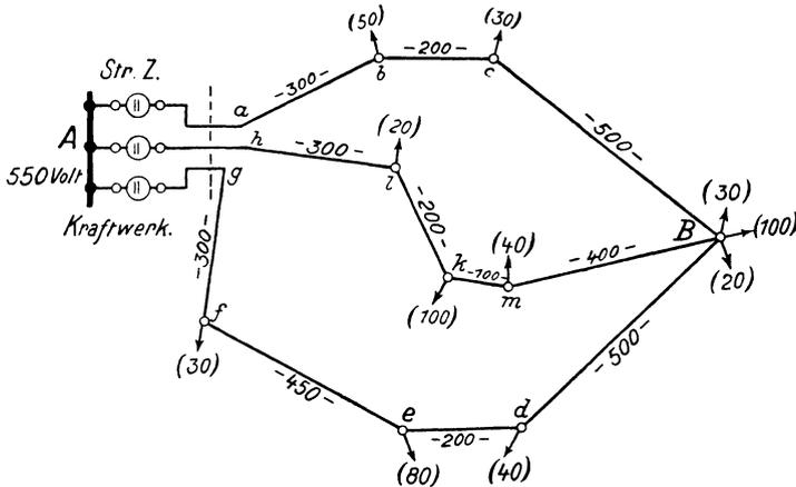
Abb. 15. Mehrfach geschlossenes oder vermaschtes Leitungsnetz.
