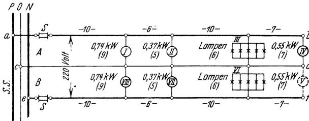
Abb. 22. Beispiel für eine Dreileiter-Verteilungsanlage.
