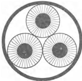
Abb. 299. Wärmefeld im Dreileiter-H-Kabel.
