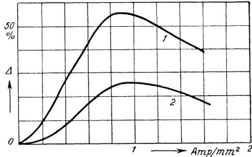
Abb. 42. Widerstandsvergrößerung bei Eisenleitungen und Wechselstrom.
