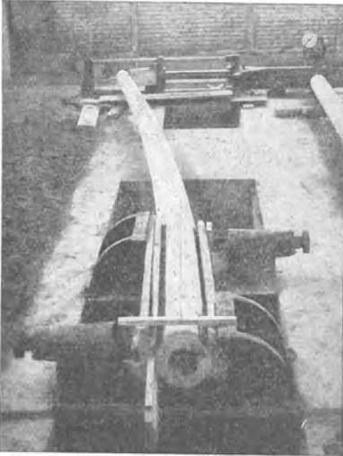
Abb. 239. Eisenbeton-Schleudermast von 13 m Länge während der Biegungsprüfung (Dyckerhoff & Widmann).
