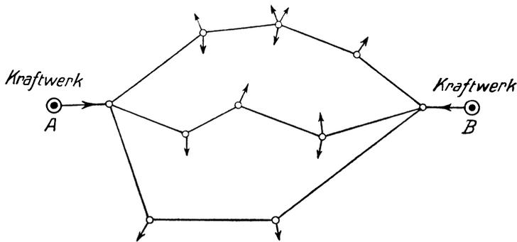
Abb. 19. Von zwei Kraftwerken gespeistes vermaschtes Netz.
