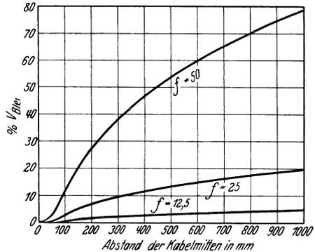
Abb. 330. Bleimantelverluste von Einfachkabeln in vH des Ohmschen Verlustes.
