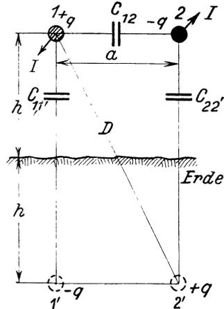
Abb. 65. Kapazitätsdarstellung für eine Einphasenleitung. (Eigenkapazität und gegenseitige Kapazität.)
