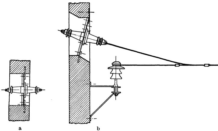
Abb. 186. Mauerdurchführungen für Mittelspannungsnetze mit Stützenisolatoren. *a* wagerechter Einbau, *b* geneigter Einbau.
