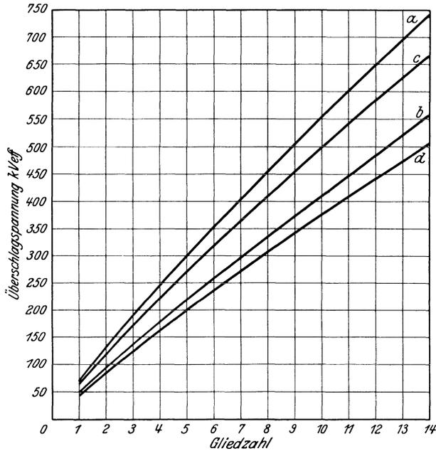
Abb. 163. Mindestüberschlagspannungen an Kettenisolatoren (Kappenisolatoren K 3 als Hängeketten)
