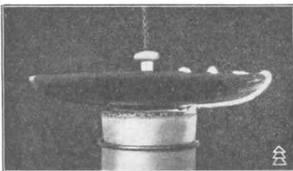
Abb. 169. Überschlag eines Kappenisolators bei Stoßspannung.
