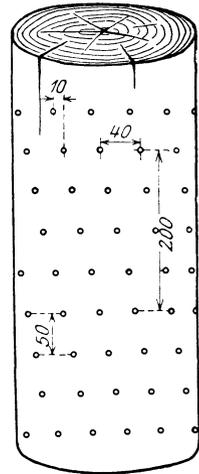
Abb. 196. Mastfuß mit Punktier-Imprägnierung.
