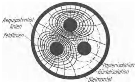
Abb. 293. Feld- und Äquipotentiallinien im Dreileiter-Gürtelkabel.
