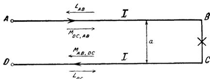
Abb. 44. Richtung der Induktionsströme bei einer Einphasenleitung.
