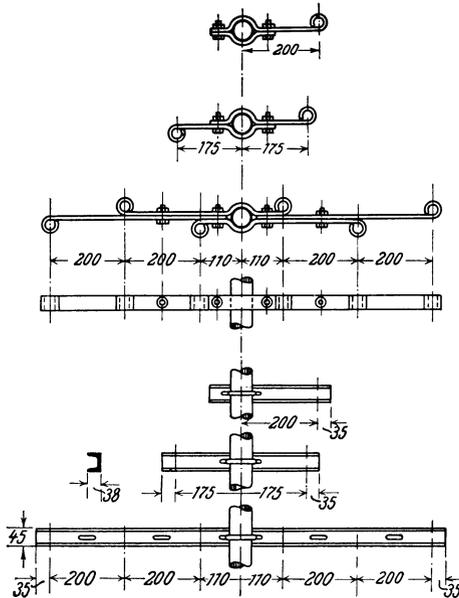
Abb. 220. Isolatorenträger für Rohrmaste.
