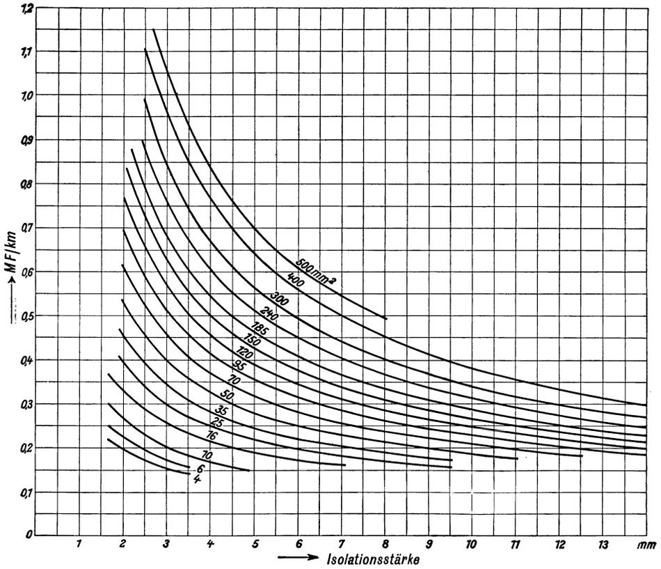
Abb. 338. Kapazität  $C_b$  von H- und Einleiterkabeln.
