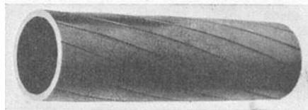
Abb. 116. Kupfer-Hohlseil, Bauart BBC, 12 Profildrähte, 400 mm<sup>2</sup> Leiterquerschnitt, 42 mm Außendurchmesser.
