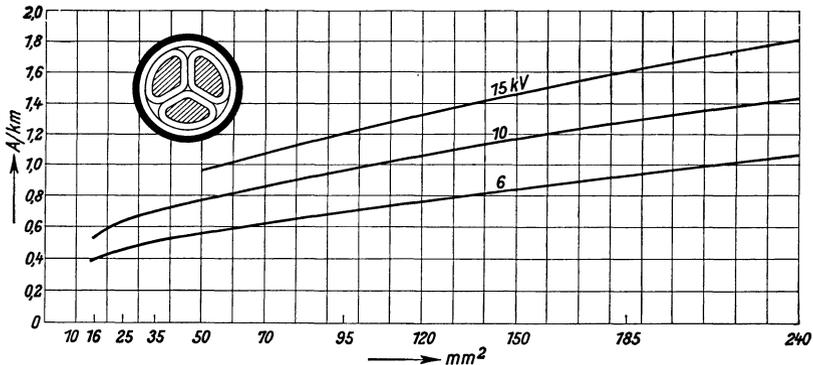
Abb. 350. Erdschlußstrom von Dreileiterkabeln mit Gürtelisolierung und Sektorleitern.
