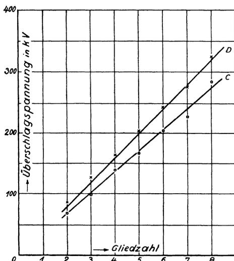
Abb. 162. Regen-Überschlagspannung ein und derselben Kette aus Hängeisolatoren in senkrechter (hängender) Anordnung (Kennlinie C) und in wagerechter Anordnung (Kennlinie D) (Leitfähigkeit des Regens  $\lambda = 250 \mu S \text{ cm}^{-1}$ ).
