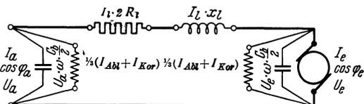
Abb. 90. Einphasen-Wechselstromfernleitung mit Ohmschem Widerstand, Selbstinduktion, Kapazität, Ableitung und Korona.
