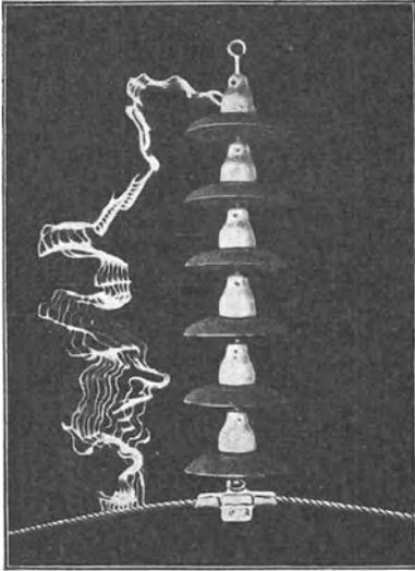
Abb. 173. Ohne Schutzvorrichtung.
