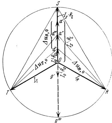
Abb. 37. Spannungsdiagramm für eine Drehstromanlage in Sternschaltung mit Nulleiter.
