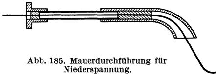
Abb. 185. Mauerdurchführung für Niederspannung.
