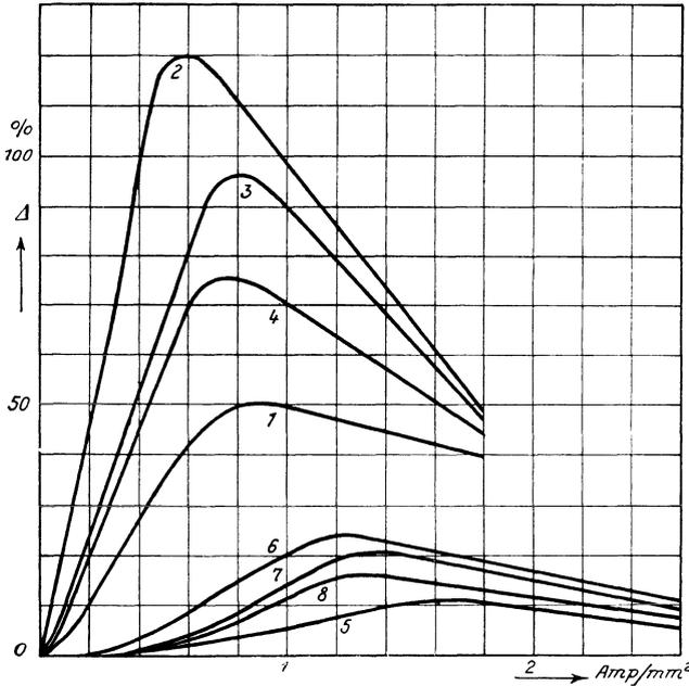
Abb. 41. Widerstandsvergrößerung bei Eisenleitungen und Wechselstrom.
