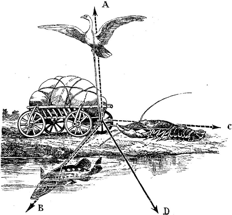
Рис. 13. Задача о лебедѣ, ракѣ и щукѣ, рѣшенная по правиламъ механики.—Равнодѣйствующая  $D$  должна сдвинуть возъ съ мѣста.
