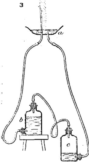
Рис. 54. Упрощенный Героновъ фонтанъ изъ аптечныхъ склянокъ.
