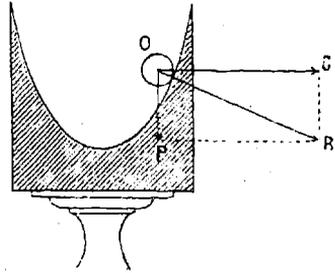
Рис. 35. Если этотъ бокаль вращать съ надлежащей скоростью, то шарикъ не скатится на его дно: равнодѣйствующая ( $R$ ) силы тяжести ( $P$ ) и центробѣжной силы ( $C$ ) будетъ прижимать шарикъ къ стѣнкѣ.
