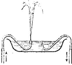
Рис. 53. Упрощенное устройство верхней тарелки Геронова фонтана.
