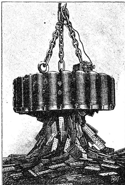
Рис. 74. Электромагнитный подъемный кранъ, переносящій желѣзныя плитки.
