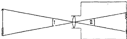
Рис. 89. Въ фотографическомъ аппаратѣ уголъ (1) равенъ углу (2), т. е. предметъ и его изображеніе видны изъ объектива подъ одинаковыми углами.
