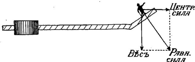
Рис. 33. Человѣкъ спокойно стоитъ на наклонной части вращающейся платформы.
