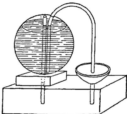
Рис. 68. Термоскопъ Герона.
