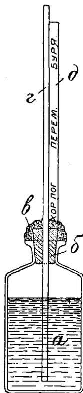
Рис. 67. Самодѣльный водяной термоскопъ, неправильно принимаемый за барометръ.
