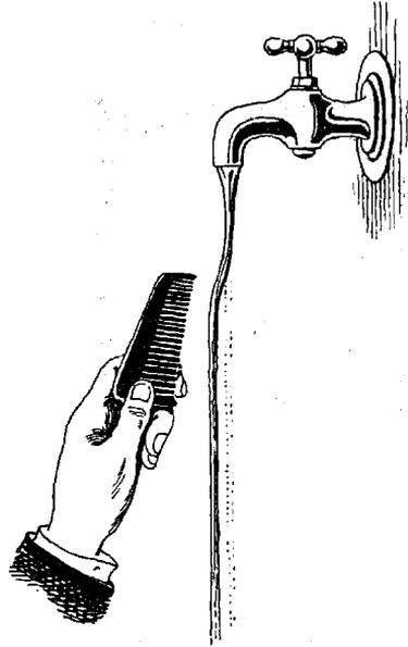
Рис. 83. Струя воды отклоняется подѣйствіемъ наэлектризованнаго гребня.
