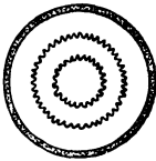
Abb. 77. Luft- vorwärmerschlot nach Schlemm.
