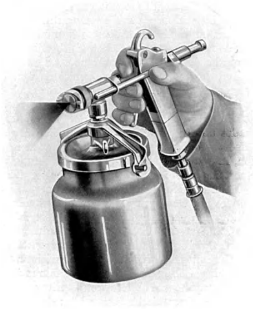
Abb. 3. Farbspritzapparat mit anhängendem Farbbehälter des Leipziger Tangier-Werks AG.
