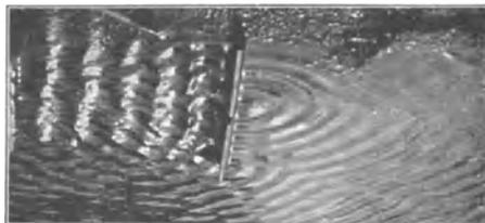
Abb. 8. Wellen, die von einem Brett zurückgeworfen werden und durch ein Loch in ihm hindurchgehen.
