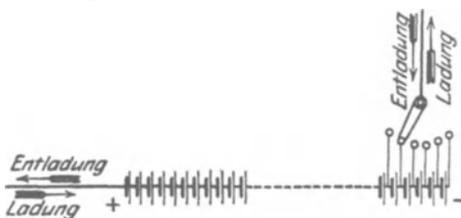
Abb. 80. Akkumulatorenatterie mit Einfachzellenschalter.
