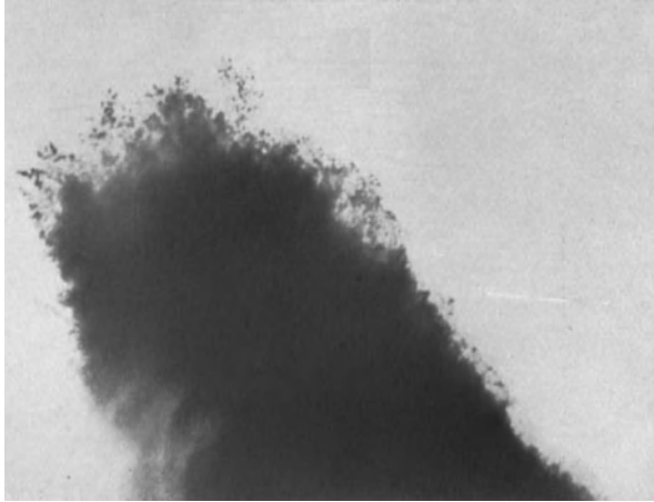
Fig. 5. Pulverkohle B (Lurgi). Deutlich sind die zahlreichen eingelagerten, die Elektronenstrahlen absorbierenden Kriställchen, vermutlich Schwermetalle oder deren Oxide (Vergr. 43 000 : 1).
