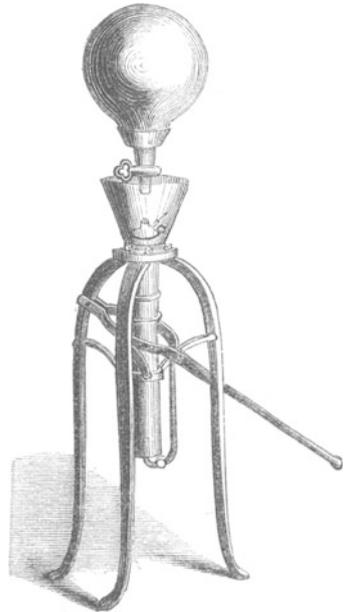
Fig. 114. Verbesserte Form der ersten Luftpumpe.
