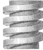
Fig. 14. Schraube mit vierseitigem Querschnitt.
