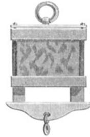
Fig. 305. Armirung des Magnets.
