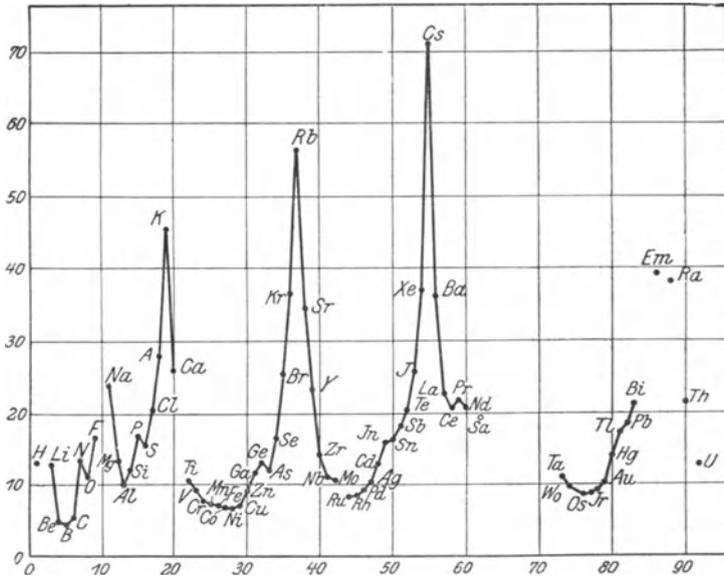
Abb. 4. Abhängigkeit des Atomvolumens der Elemente von der Atomnummer.
