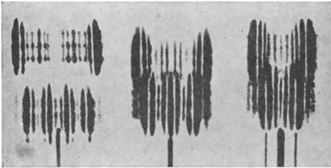
Abb. 6. Der Stark-Effekt der Wasserstofflinien  $H_\delta$ ,  $H_\gamma$  und  $H_\beta$ .
