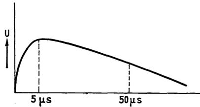
Bild 27. Spannungskurve des Stoßgenerators.
