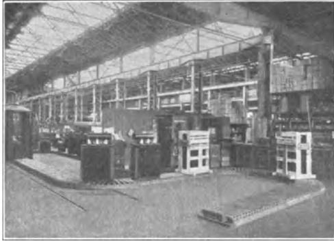
Bild 20. Fertigmachen und Verpacken von Transformatoren.
