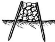
Abb. 78 a und b. Buhnen aus Steinschüttung zwischen Pfahlreihen.
