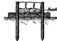
lich an der Ostsee häufig ausgeführt werden. Bisweilen wird unter der Steinschüttung eine Faschinenunterlage angeordnet. Diese Bauart ist auch an der Nordsee auf Borkum mit Erfolg angewendet worden.
