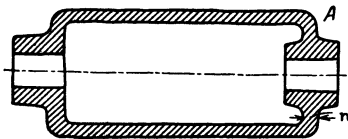
Abb. 131. Falsch. (Gefahr der Kernverlagerung!)
