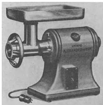
Abb. 63. Laden-Fleischwolf des Alexanderwerks mit SSW-Einphasen-Kondensatormotor 0,25 kW, 1500 U/m, umschaltbar von 110 auf 220 V, mit im Gehäusefuß eingebautem Kondensator.
