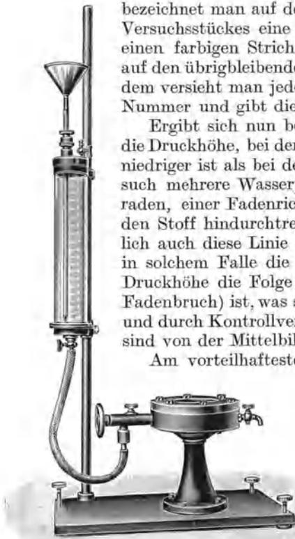
Abb. 167. Wasserdruckprüfer von Schopper.
