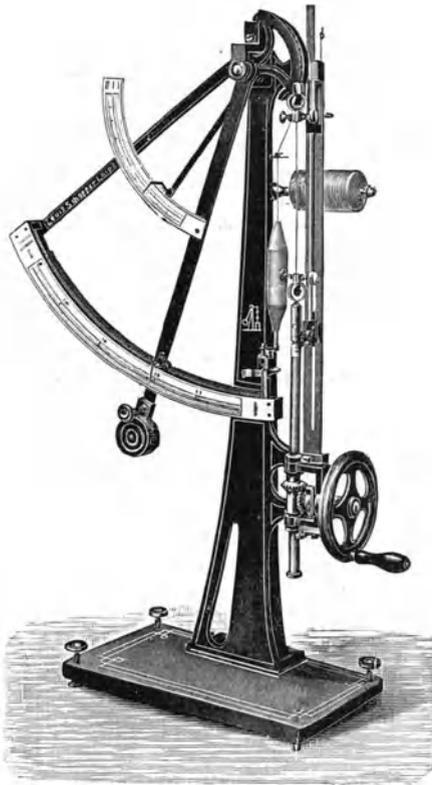
Abb. 118. Garnfestigkeitsprüfer mit Handantrieb nach Schopper.
