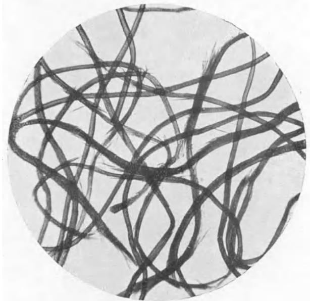
Abb. 62. Wollhaare aus einer beschädigten Stelle eines Schußfadens (nach Heermann).
