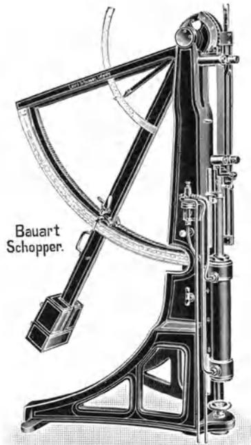
Abb. 121. Gewebefestigkeitsprüfer nach Schopper.
