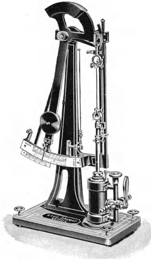
Abb. 120. Schopperscher Festigkeitsprüfer für Fasern, Faserbündel und Haare.
