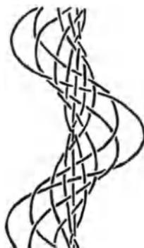
Fig. 151. Achtfädiges Geflecht mit verschiedener Fädenspannung.
