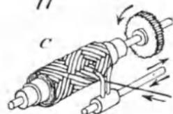
Fig. 78. Kreuzspuler mit Wickeltrommel und angetriebenem Spulendorn.
