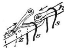
Fig. 168. Ösennadel zum Mindern bei der Zungenadel.
