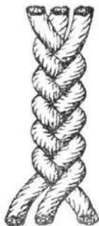
Fig. 3. Ansicht eines dreifädigen Geflechtes (geflochtene Schnur).
