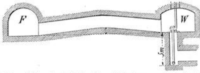
Abb. 683. Sattelförmige Erhebung der Sohle zwischen Förderstrecke und Pumpenkammer.
