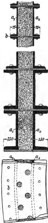
Abb. 282. Schachtauskleidung aus Profilstahl (mit Beton-Zwischenfüllung).
