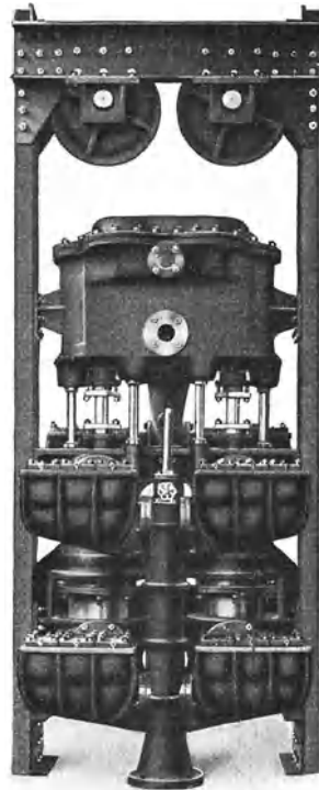
Abb. 689. Duplexpumpe für Abteufzwecke von Otto Schwade & Co. zu Erfurt (für 3,2 m 3 minutlich auf 200 m Druckhöhe).
