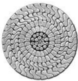
Abb. 622. Verschlossenes Seil mit je zwei Draht- lagen.
