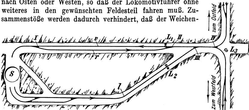
Abb. 537. Füllort für Durchschiebebetrieb mit Stellwerk.
