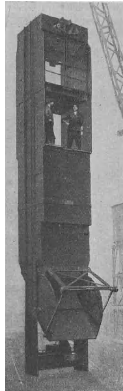
Abb. 596. Gefäß mit Bodenentleerung und Seilfahrttragböden.
