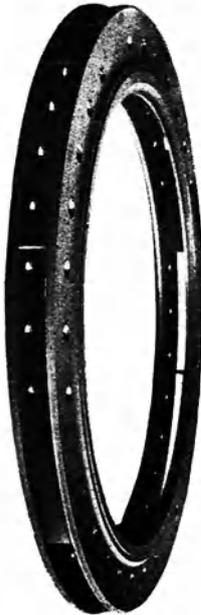
Abb. 68. Leitrad vor dem Einsetzen der drehbaren Diffusorscheufeln (BBC).
