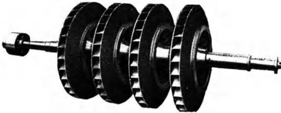
Abb. 86. Läufer des Demag-Gasgebläses.
