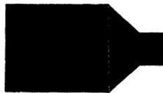
Abb. 106a. Form der Staniolbelege für gelegte Kondensatoren.
