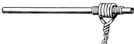
Abb. 150. Drahtverbindung am Graphitstab.
