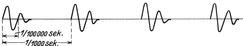
Abb. 15. Serie von gedämpften Wellenzügen eines Funkensenders mit 1000 Funken in der Sekunde. Da die Schwingungsdauer  $\frac{1}{100000} \text{ sec}$  ist, ist die Wellenlänge 3000 m. (Siehe die Gleichung S. 10.)
