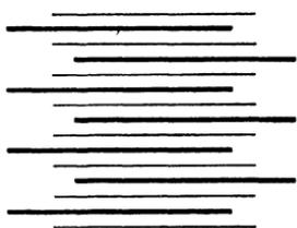
Abb. 106 b. Blockkondensator.
