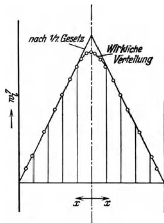
Abb. 62. 1/2 . Gesetz und wirkliche Geschwindigkeitsverteilung. Vergleich des gemessenen und des rechnerischen Profils.
