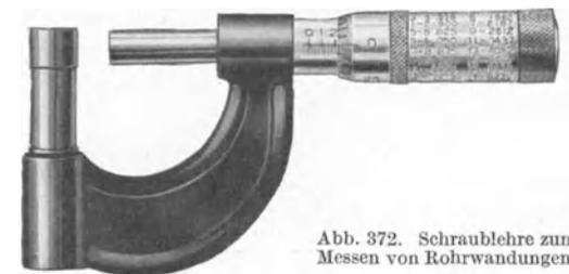
Abb. 372. Schraublehre zum Messen von Rohrwandungen.
