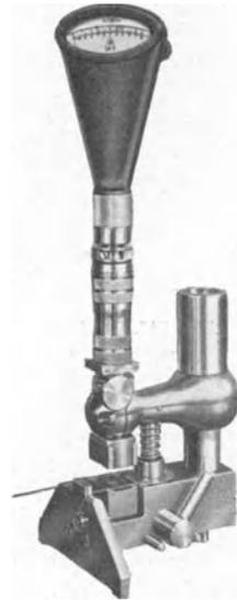
Abb. 241. Drahtmeßeinrichtung mit Mikrotast.
