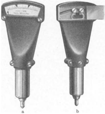
Abb. 231. Minimometer mit erweitertem Meßbereich.
