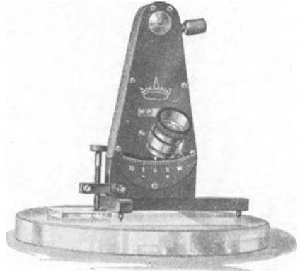
Abb. 556. Fühlhebel zur Ebenheitsprüfung.
