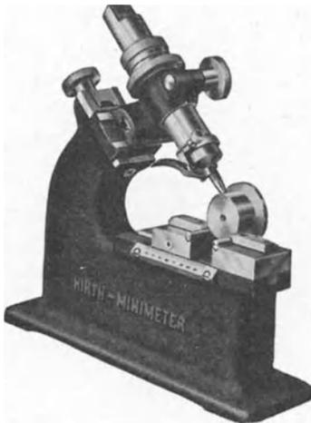
Abb. 243. Minimetergestell zum Messen von Zylindern.
