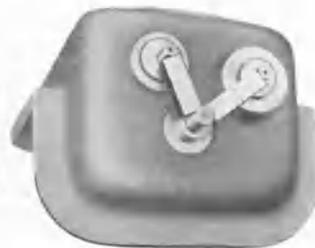
Abb. 72. Prüfung des Abstandes der Bohrungsachsen.
