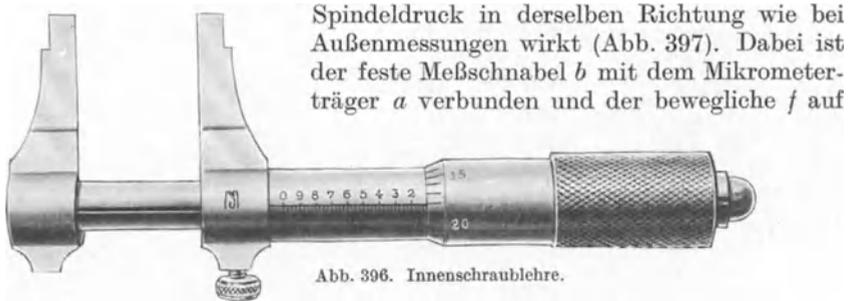
der dreh- und verschiebbaren, durch *b* hindurchgeführten Spindel *d* mittels Mutter *g* so befestigt, daß er sich zwar verschieben kann, durch Führung in dem Schlitz *h* der Hülse *c* aber gegen Drehung gesichert ist.
