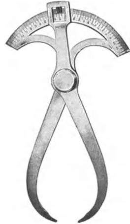
Abb. 147d. Taster mit Skala.
