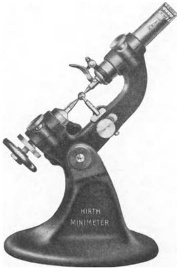
Abb. 239. Minimertgestell zum Messen von Kugeln.
