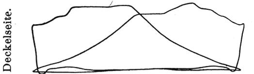
Fig. 224. Hochdruck-Luftcylinder.
