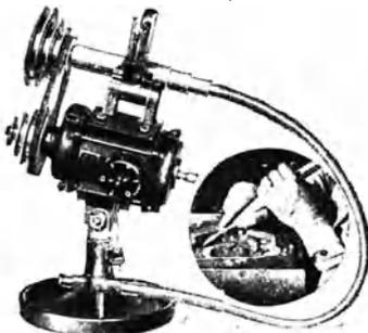
Abb. 40. Elektrische Handfeil-, -fräs-, -schleif-, -poliermaschine (Bauart Fein, Stuttgart).
