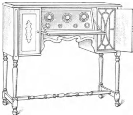
Abb. 112. Dayton-Empfangsständer mit neben dem Röhrenempfänger eingebautem Lautsprecher.
