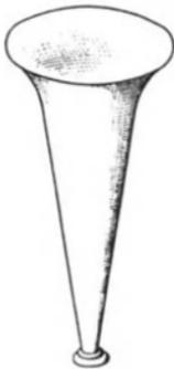
Abb. 41. Kegelförmiger Trichter. Bei allen älteren Radioanlagen angewendet.
