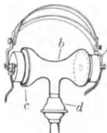
Abb. 63. T-Rohrstück mit einem Doppelkopfhörer behelfsmäßig verbunden.
