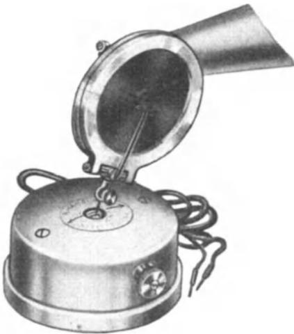
Abb. 73. Lose Verbindung der normalen Schalldose eines Grammophons mit der Lautsprecherschalldose.
