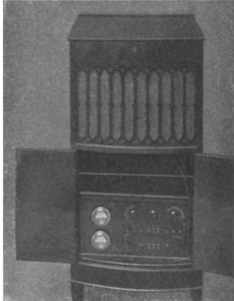
Abb. 116. Lautsprecher mit Kraftverstärker.
