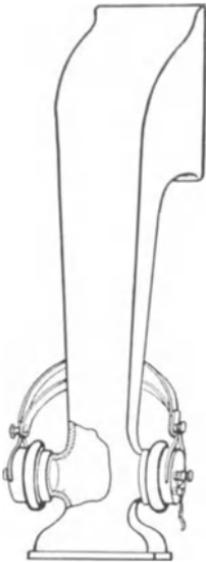
Abb. 64. Radiohorn, verbunden mit einem Doppelkopftelephon.
