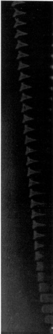
Abb. 105. Flammenbewegung in Benzol-Luftgemischen (20% überfettet) in einem Rohr von 5 cm Durchmesser (wovon 4 cm bei der Aufnahme freigelegt); Aufnahmen mit dem Thyraxen Zeitdehner (1240 Bilder/s). Nach den ersten Stadien findet ein „Umkippen“ der Flammenfront statt; im Innern des Rohres starke, gegen die Flamme gerichtete Strömung, entsprechende Flammenform (wie ein nach unten brennender Bunsenkonus). Die rechts unten sichtbaren leuchtenden Partien rühren durch das Abreißen von Frischgas bedingt sein, welches von dieser Gasströmung hinter die Flammenfront geführt worden ist. Die Aufnahme wurde von Herrn H. SCHULZE, Benzol-Verband, Bochum, zur Verfügung gestellt.
