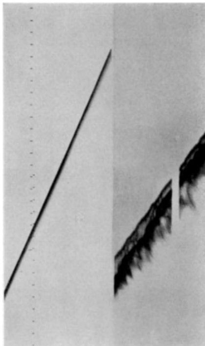
Abb. 70. Aufnahmen gleichförmiger Flammenbewegung. (Nach MAXWELL und WHEELER.) The Science of Petroleum, Bd. IV. Oxford 1938.
