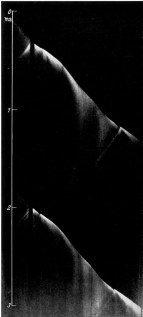
Abb. 137. Aufnahme der Detonation von 2\text{CO} + \text{O}_2 in einem Rohr von 3,62 mm Durchmesser. (Nach BONE, FRASER, WHEELER: Zitiert S. 191.) Der untere Teil der Abbildung stellt die Fortsetzung des im oberen erfaßten Vorganges dar.
