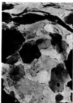
Abb. 21. Kaolin im Übermikroskop. (Nach EITEL und H. O. MÜLLER [34].) Elektronenoptische Abbildung 25 500 : 1.
