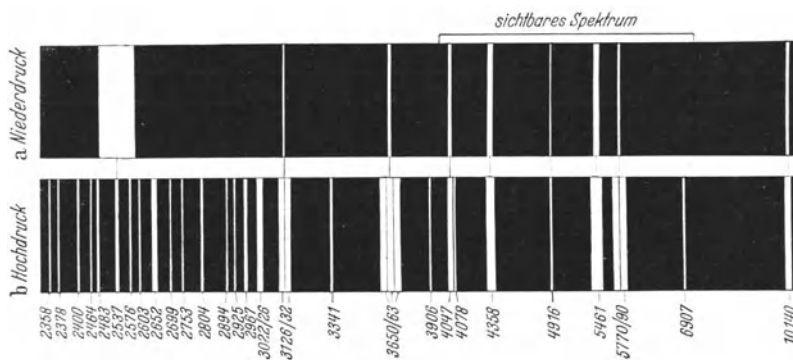
Abb. 3. Quecksilberspektrum bei Hoch- und Niederdruckentladung (die Breite der gezeichneten Linien ist ein ungefähres Maß für ihre Intensität).
