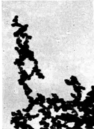
Abb. 12 a und b. Übermikroskopische Aufnahmen von Ruß. a Zedernölluß nach v. BORRIES und RUSKA [14]. Magnetisches Übermikroskop 1939. Gesamtvergrößerung 25 000:1. b Benzolluß nach MAHL [36 a]. Elektrostatisches Übermikroskop 1940. Gesamtvergrößerung 25 000:1.
