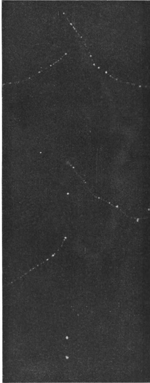
Abb. 16. Nebelspur-Aufnahme von der Auslösung von Elektronen durch Röntgenstrahlen (C. T. R. WILSON, nach MÜLLER-POULLETT, Physik, Bd. IV/3).
