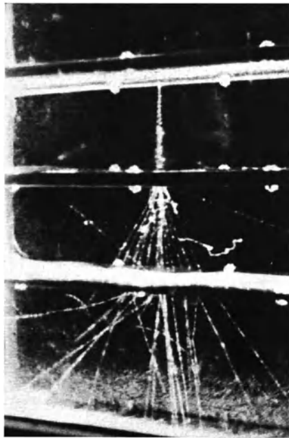
Abb. 19. Entwicklung eines Kaskadenschauers (Aufnahme von FUSSEL 1938).
