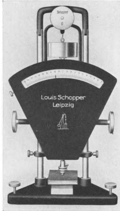
Abb. 29. Kugeldruckgerät zur Untersuchung von Gummi (Schopper, Leipzig).
