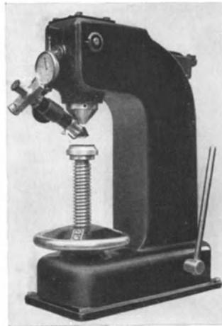
Abb. 50. Brinell- und Vickers-Prüfer (Mohr Federhaff, Mannheim).
