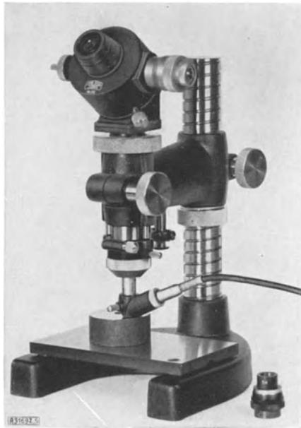
Abb. 35. Ablesemikroskop mit Beleuchtung (Zeiss, Jena).
