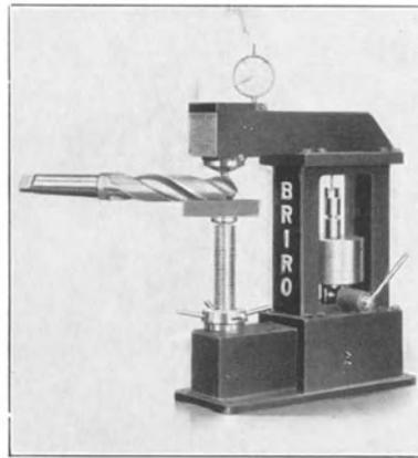
Abb. 41. Vorlast-Härteprüfer (Reicherter Eßlingen).
