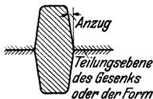
Abb. 129. Kurbelwangenquerschnitt.
