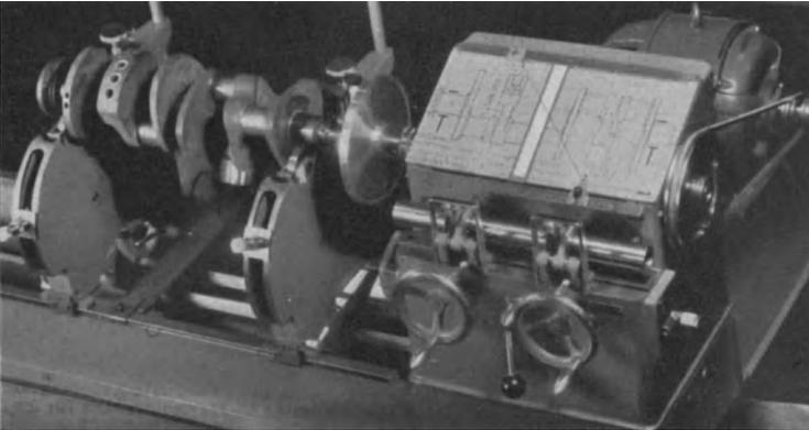
Abb. 142. Neuzeitliche Maschine zur Serienwuchtung von Kurbelwellen (SCHENCK)
