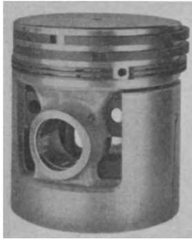
Abb. 23. „Schmalstreifen“-Nelsonkolben (Opel 1931).
