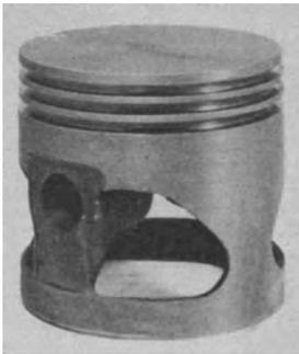
Abb. 11. „Skelett“-Kolben (Chevrolet-Graugußkolben).
