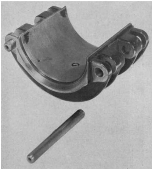
Abb. 64. Deckel und Kegelstift zum Pleuelstangenteil Abb. 63.
