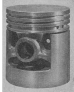
Abb. 24. „Breitplatten“-Nelsonkolben (Daimler 1933).
