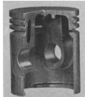
Abb. 29. MEC-Kolben mit innerer und äußerer Abstützung des Bodens (Opel P 4 1936).
