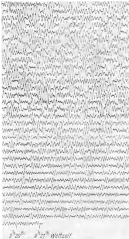
Abb. 69. Brandungsunruhe in Potsdam. Aufgezeichnet vom elektromagnetischen Galtzin-Wilip-Seismographen.
