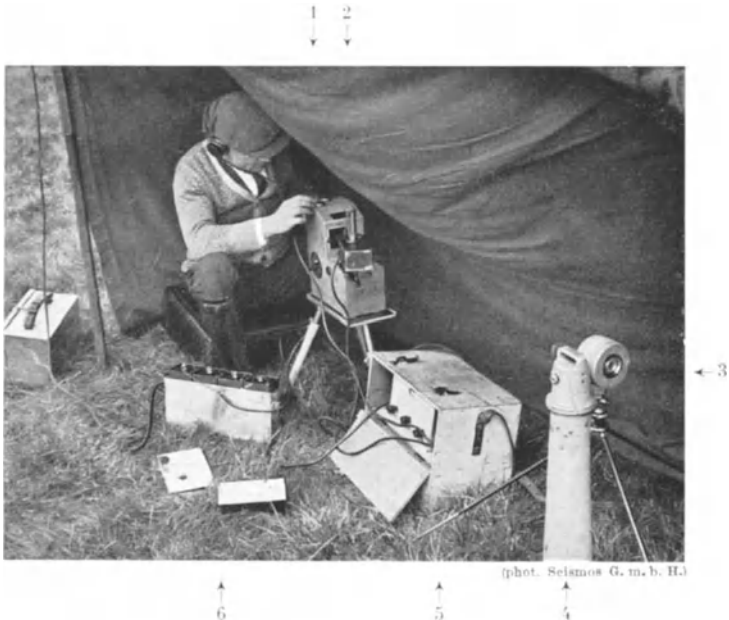
Abb. 73. Mintrop-Seismograph im Zelt. 1. Registrierapparat („Lichtschreiber“). 2. Vorrichtung zur photographischen Aufzeichnung des Sprengmoments (Oszillograph). 3. Schallempfänger (zur Messung des Sprengpunkt- abstandes). 4. Transportabler Seismograph von Mintrop. 5. Empfänger für die funkentelegraphische Übertragung des Sprengmomentes (und Verständigung mit Schießmeister am Sprengort). 6. Stromquelle für Registrierlampen und Empfänger.
