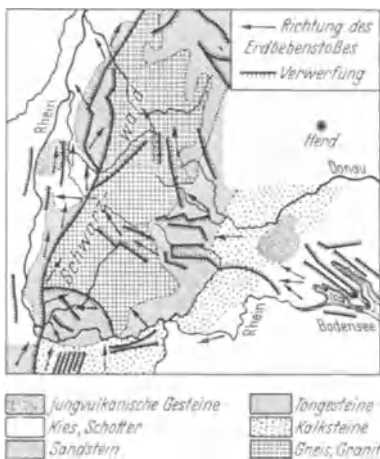
Abb. 19. Süddeutsches Beben vom 16. November 1911. Abhängigkeit der Stoßrichtung vom Aufbau des Untergrundes.
