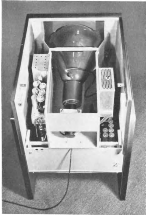
Abb. 199. Innenansicht eines Empfängers mit magnetischer Ablenkung für beide Richtungen (Telefunken FE IV, 1935/36).
