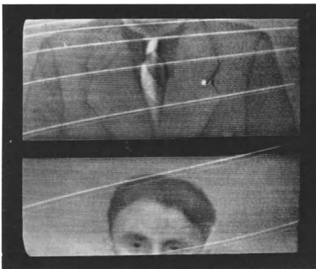
Abb. 194. Fernbild bei durchlaufender Phase der Bildkippschwingung.
