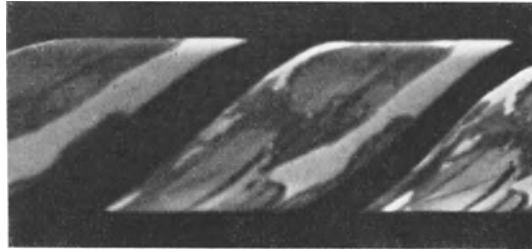
Abb. 192. Fernbild bei Übersteuerung des Verstärkers für die Bildsägezahnspannung, mit seitlich geschwenkter Kamera aufgenommen.
