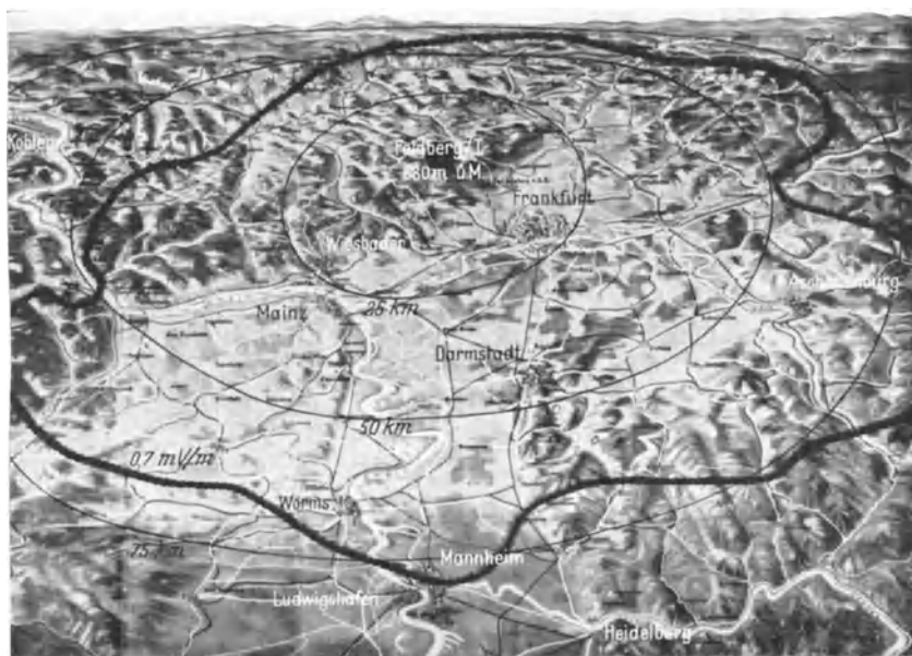
Abb. 10. Reichweite des Versuchs-Fernsehenders auf dem Feldberg (Taunus). Feldstärkelinie 0,7 mV/m.
