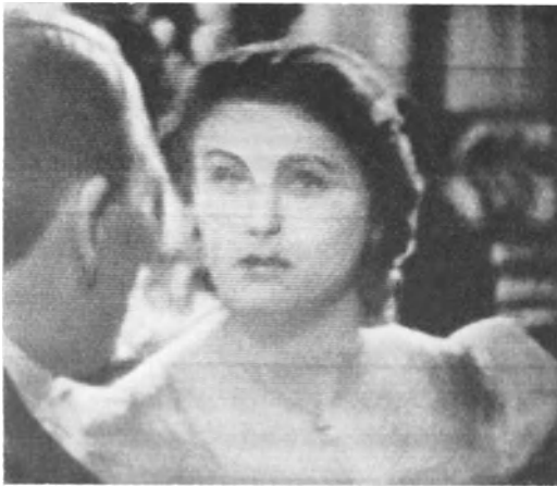
Abb. 203. 180-Zeilen-Fernsehbild bei guter Einstellung, unretuschierte Momentaufnahme.
