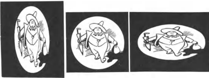
Abb. 78. Bilddehnung durch elektronenoptische Zylinderlinsen. Mitte Ausgangsbild.
