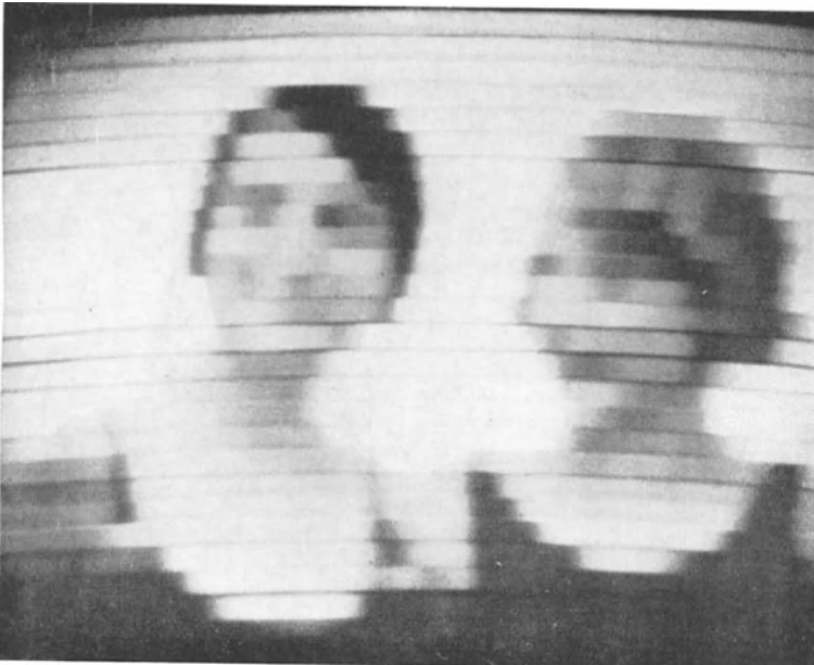
Abb. 4 a. Nachbildung des Fernbildes durch optische Rasterung: 30 Zeilen, 1200 Bildpunkte.
