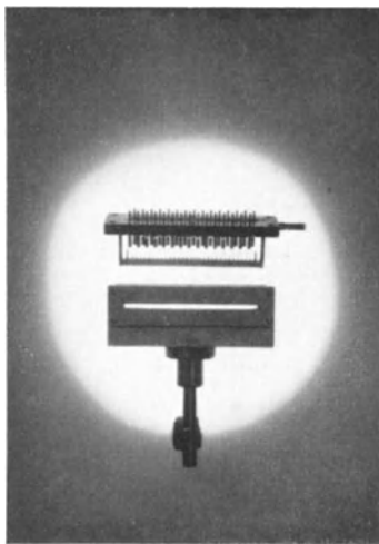
Abb. 212. Kerr-Zellenzeile mit linearem Trog.
