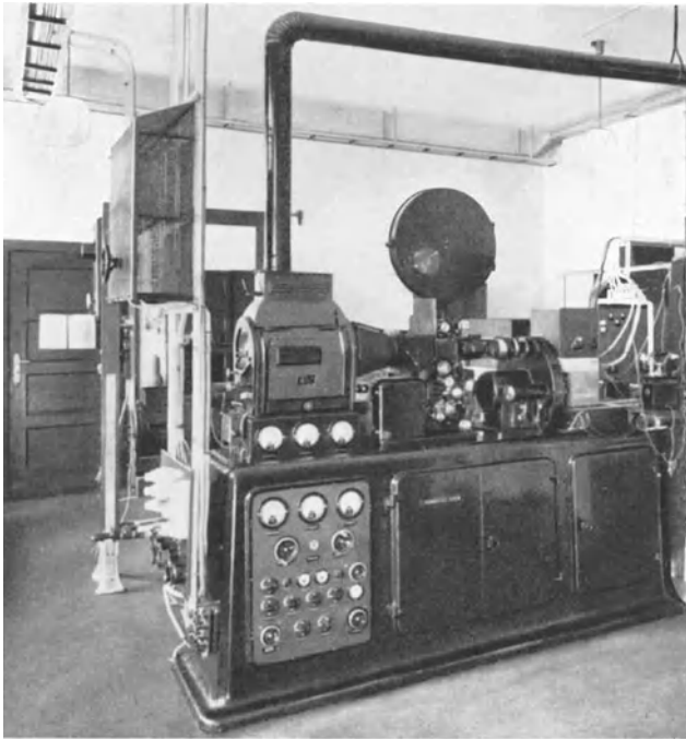
Abb. 60. Filmgeber mit Kreislochscheibe, gebaut von der Fernseh-A.-G., Fernseh-Aufnahmerraum Berlin-Witzleben.
