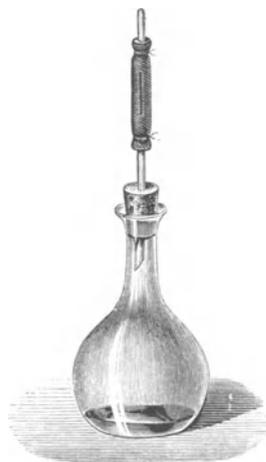
und bewirkt dadurch einen hermetischen Verschluss. In Fig. 32 hat eine Wandung der Kautschukröhre, welche oben mit einem Stückchen Glasstab verschlossen ist, einen scharfen Schnitt mit einem feinen Messer erhalten. Da derselbe von aussen erfolgt ist, so werden die Ränder auch durch Druck von aussen fest zusammengepresst, während sie auf Druck von innen sich öffnen. Es kann also auch hier Wasserdampf aus-, aber keine Luft eintreten.
