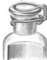
Druckfläschchen erwähnt worden. Auch für die Bestimmung des Eisengehaltes in den Eisenpräparaten des Arzneibuches benützte man diese Vorrichtungen, da nach den Vorschriften desselben die Eisenoxydsalzlösung mit Jodkalium „bei einer 40° nicht übersteigenden Wärme im verschlossenen Gefässe eine halbe Stunde“ stehen sollte. Der Nachtrag zum Arzneibuch hat durch Aenderung dieser Vorschriften die Verwendung der Druckfläschchen für den letzteren Zweck überflüssig
