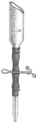
Bei den Quetschhahnbüretten wird der Verschluss durch ein Stückchen Kautschukschlauch bewirkt, welches über das untere, etwas angeschwellte Ende der Bürette gezogen und durch einen Quetschhahn zusammengepresst ist. (Fig. 1.)
