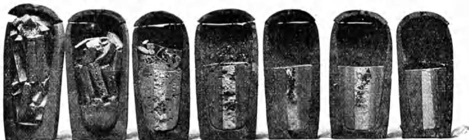
Abb. 7. Zustand des Schmelzgutes im Tiegel (an der Luft erkaltet)
