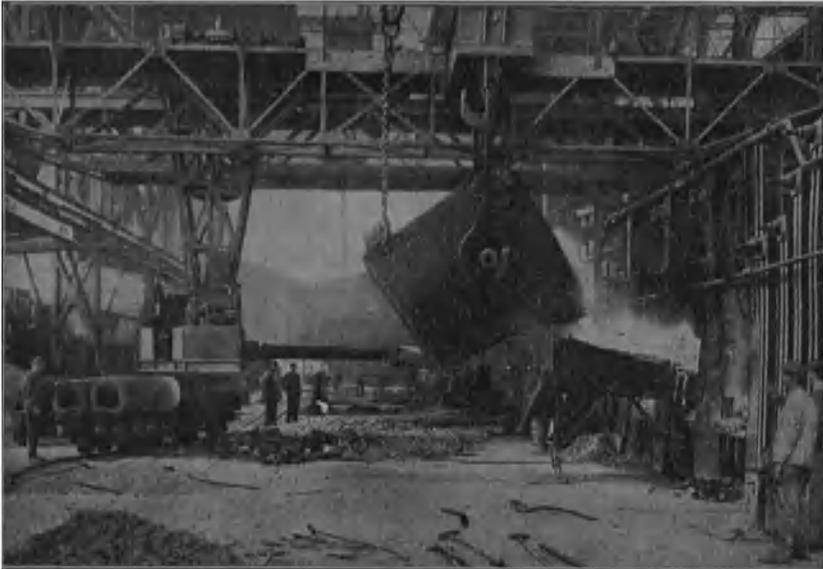
Abb. 6. Beschickung des Siemens-Martin-Ofens.
