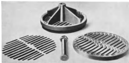
Abb. 76. Streifenventil. (Aus Ostertag [1].)
