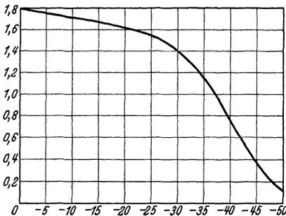
Abb. 17. Ordinate Steilheit (mA/V) bei einer Steuergittervorspannung von  $-3\text{ V}$  und normaler Schirmgitter- und Anodenspannung. Röhre AF 3. Abszisse Vorspannung des Fanggitters gegenüber der Kathode.
