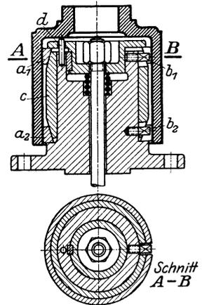
Abb. 115. Rundbearbeitungs-Spannvorrichtung (Gegenentwurf zu Abb. 114).  $a_1$  und  $a_2$  Klemmringe, durch Stifte  $b_1$  und  $b_2$  am Verdrehen behindert. *c* Kegelhülse. *d* entfernungsbestimmender Anschlagstift.
