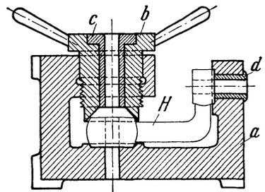
Abb. 130. Fehlerhafte und unvollständige Kippbohrspannvorrichtung.
