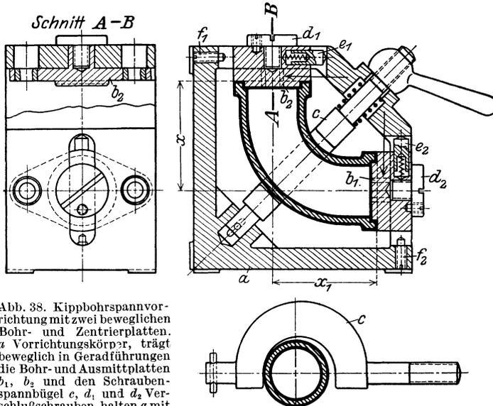
Abb. 38. Kippbohrspanvorrichtung mit zwei beweglichen Bohr- und Zentrierplatten.  $a$  Vorrichtungskörper, trägt beweglich in Geradföhrungen die Bohr- und Ausmittplatten  $b_1$ ,  $b_2$  und den Schraubenspannbügel  $c$ ,  $d_1$  und  $d_2$  Verschlusschrauben, halten  $a$  mit  $b_1$  zusammen.  $e_1$  und  $e_2$  unter Federdruck stehende Bolzen, drücken beim Entspannen  $b_1$  und  $b_2$  rechtwinklig in Pfeilrichtung gegen Anschlagsschrauben  $f_1$  und  $f_2$ .
