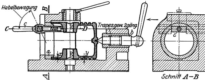
Abb. 80. Standbohrspannvorrichtung mit doppelter Werkzeugführung.
