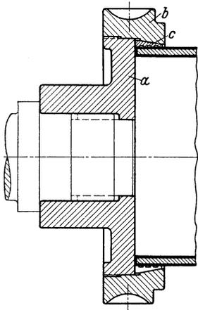
Abb. 11. Spannfutter für kleine Spanndurchmesser.
