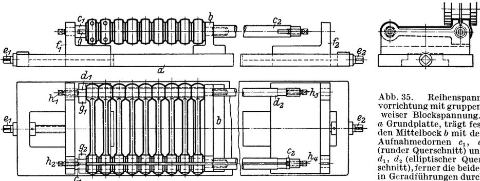
Abb. 35. Reihenspannvorrichtung mit gruppenweiser Blockspannung. *a* Grundplatte, trägt fest den Mittelbock *b* mit den Aufnahmedornen *c*<sub>1</sub>, *c*<sub>2</sub> (runder Querschnitt) und *d*<sub>1</sub>, *d*<sub>2</sub> (elliptischer Querschnitt), ferner die beiden in Geradföhungen durch Spindeln *e*<sub>1</sub>, *e*<sub>2</sub> bewegliche Werkstücke gedrückt.
