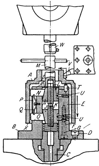
Abb. 114. Rundbearbeitungs-Spannvorrichtung, zu vielgestaltig.
