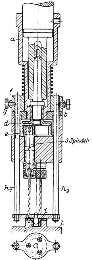
Abb. 45. Dreispindelkopf mit Bohrspannvorrichtung.
