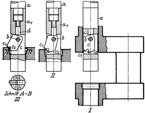
Abb. 51. I...III. Rillenschneider für schlecht zugängliche Stellen. *a* und *a*<sub>1</sub> zweiteilige Bohrstanze, trägt auf Bolzenschraube *b* das Rillenschneidmesser *c* mit Anschlag Nase *c*<sub>1</sub> und Rillenschneide *c*<sub>2</sub>. *d* Federbolzen, drückt *c* in die Ruhestellung II.
