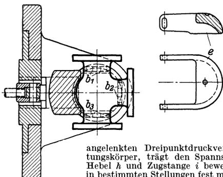
Abb. 29. Schwenkbare Rundbearbeitung-Spannvorrichtung mit Preßluftfeststellung. a schwenkbarer Aufnahmekörper, trägt zum Stützen und Ausmitten die drei prismatischen Knaggen  $b_1 \dots b_3$  (Dreipunktauf-
