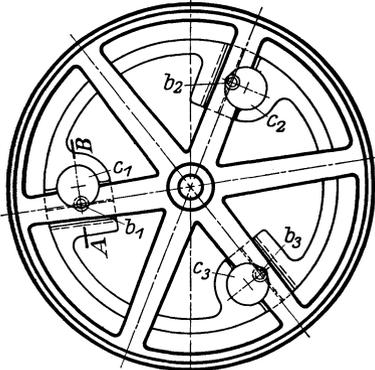
Abb. 90. Fliegende Rundbearbeitung-Spannvorrichtung.
