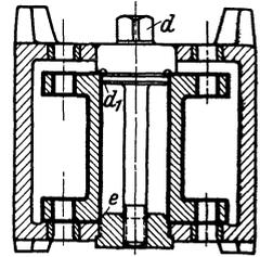
Abb. 129. Kippbohrspannvorrichtung mit richtiger Anordnung der Spannschraube (Gegenentwurf zu Abb. 128). Spannschraube *d* drückt das Werkstück auf die untere Gehäusewand. *d*<sub>1</sub> mittelt das Werkstück oben, *e* unten.
