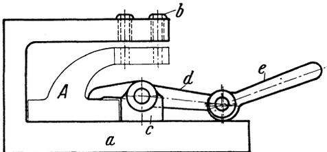
Abb. 144. Schlecht eingespanntes Werkstück.
