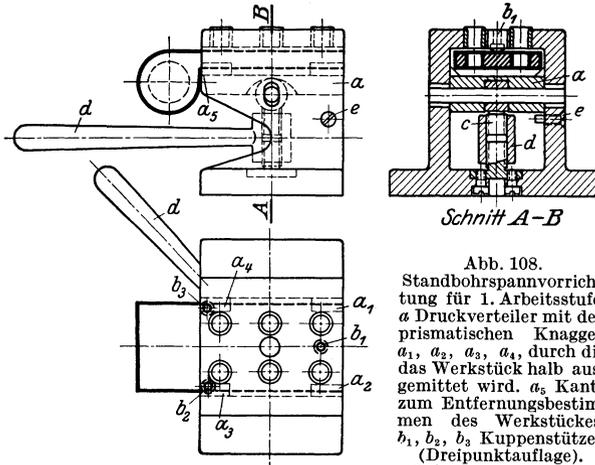
Abb. 108. Standbohrspannvorrichtung für 1. Arbeitsstufe. *a* Druckverteiler mit den prismatischen Knagen *a*<sub>1</sub>, *a*<sub>2</sub>, *a*<sub>3</sub>, *a*<sub>4</sub>, durch die das Werkstück halb ausgemittet wird. *a*<sub>5</sub> Kante zum Entfernensbestimmen des Werkstückes. *b*<sub>1</sub>, *b*<sub>2</sub>, *b*<sub>3</sub> Kuppenstützen (Dreipunktaufgabe). *c* Spannschraube an *a* (Rechts- und Linksgewinde, achsrecht bewegt). *e* Anschlagsschraube, begrenzt *a* in der Abwärtsbewegung.
