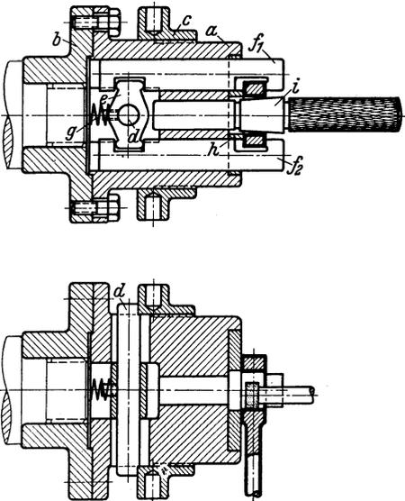
Abb. 26. Achsenspannfutter zum Schleifen.
