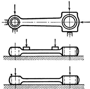
Abb. 32...34. Spannkraften beim Bohren von Schubstangen.
