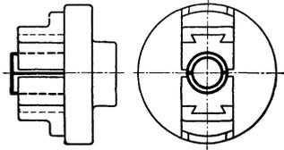
Abb. 102. Zweibackenfutter zum Ausbohren von Lagerschalen.
