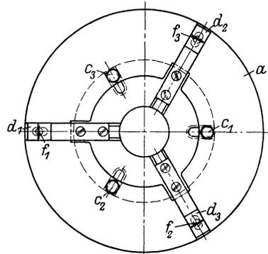
Abb. 127. Vergrößertes Dreibackenfutter als Sonderspannvorrichtung (Gegenentwurf zu Abb. 126).
