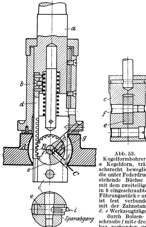
Abb. 53. Kugelformbohrer. *a* Kegeldorn, trägt achsrecht beweglich die unter Federdruck stehende Büchse *b* mit dem zweiteiligen in *b* eingeschraubten Führungsstück *c* und ist fest verbunden mit der Zahnstange *d*. *e* Werkzeugträger, durch Bolzenschraube *f* mit drehbar verbunden und mit *d* im Eingriff stehend. *g* Befestigungsschraube. *h* Stellschraube für den Schneidstahl *i*.
