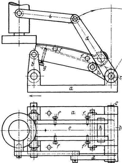
Abb. 56. Schleifvorrichtung für gekrümmte Flächen.
