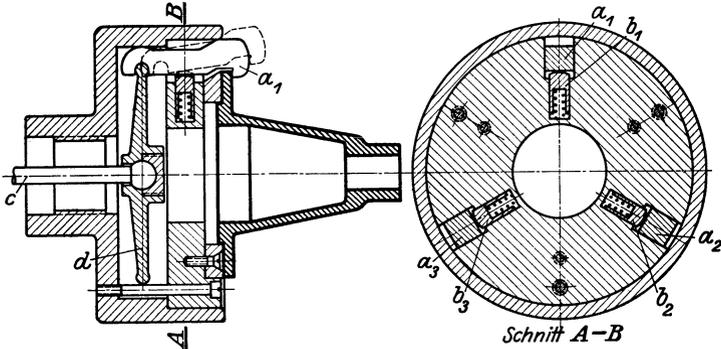
Abb. 25. Achsenspannfutter für Außenspannung.
