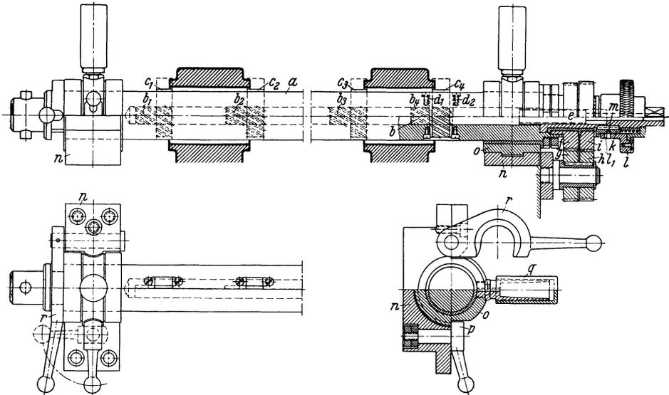
Abb. 111. Abflächvorrichtung zur Bohrspannvorrichtung Abb. 110.
