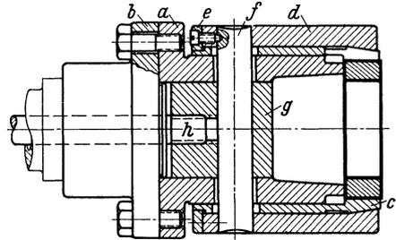
Abb. 19. Tiefspannfutter für Außenspannung. *a* Vorrichtungskörper, mit Drehbankmitnehmerscheibe *b* fest verbunden. *c* Spannzanze, auf *a* in Achsenrichtung ein wenig beweglich. *d* Spannbuchse, auf *c* in Achsenrichtung ein wenig beweglich und durch Haltering *e* in dieser Bewegung begrenzt. *f* Verbindungsbolzen, sitzt fest in *d* und *g*. *h* Kolbenstange des Preßluftspanners, mit *g* fest verbunden.
