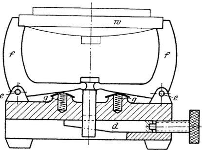
Abb. 126. Schlecht durchgebildete und zu teure Spannvorrichtung.
