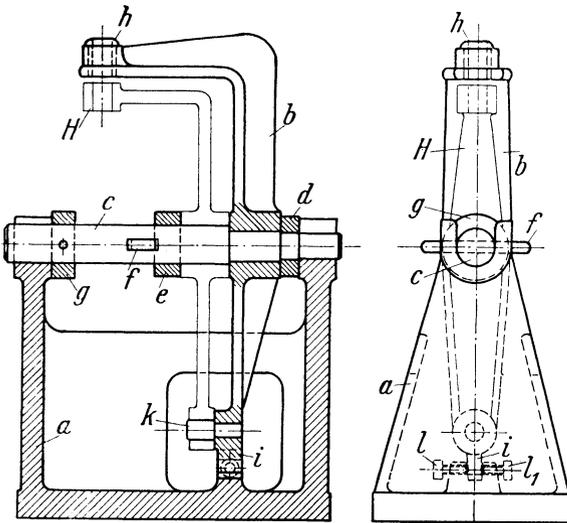
Abb. 138. Stark fehlerhafte und zum Bohren ganz ungeeignete Bohrvorrichtung.
