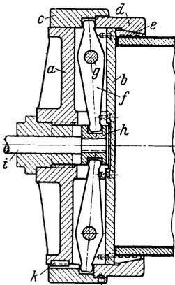
Abb. 14. Spannfutter für großen Spanndurchmesser und Preßluftbetrieb.
