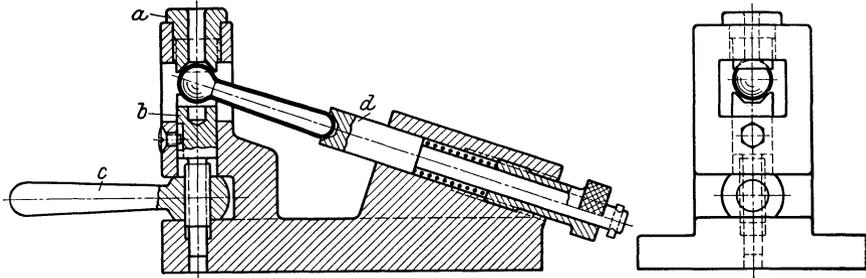
Abb. 143. Standbohrspanvorrichtung für Griffmutter verschiedener Abmessung (Gegenentwurf zu Abb. 142). *a* Ausmitt- und Führungsbüchse als Stütze gegen den Spanndruck. *b* Druckstück, durch Griffmutter *c* nach oben spannend. *d* richtungbestimmendes Druckstück
