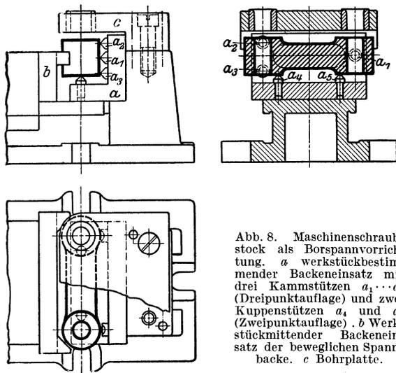
Abb. 8. Maschinenschraubstock als Bohrspannvorrichtung. *a* werkstückbestimmender Backeneinsatz mit drei Kammstützen  $a_1 \dots a_3$  (Dreipunktauflage) und zwei Kuppenstützen  $a_4$  und  $a_5$  (Zweipunktauflage). *b* Werkstückmittiger Backeneinsatz der beweglichen Spannbacke. *c* Bohrplatte.
