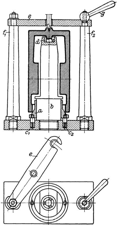
Abb. 85. Bohrspannvorrichtung zum mittigen Anbohren von Kolben.
