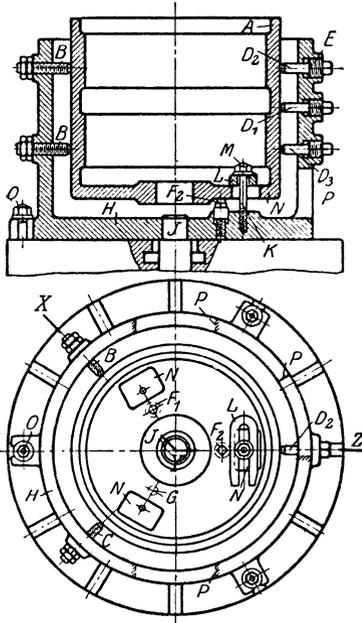
Abb. 112. Rundbearbeitungs-Spannvorrichtung mit schlechter Wirkungsweise.
