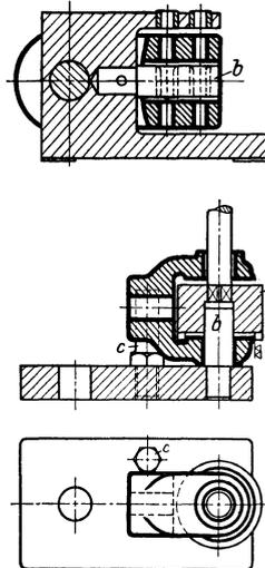
Abb. 95. Standbohrspannvorrichtung mit Dornführung.  $a$  Senkwerkzeug, führt sich auf den Dorn  $b$ .  $c$  Anschlagdorn.
