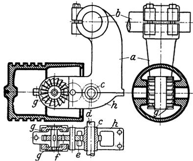
Abb. 81. Fräsvorrichtung (werkzeugtragende Arbeitsvorrichtung). *a* Vorrichtungskörper, wird auf Fräsmaschinenausleger *b* befestigt. *c* Stirnrad, sitzt fest auf verlängerter Frässpindel *d* und treibt durch die Räder *e* und *f* das Fräserpaar *g* an. *h* Unterteil.
