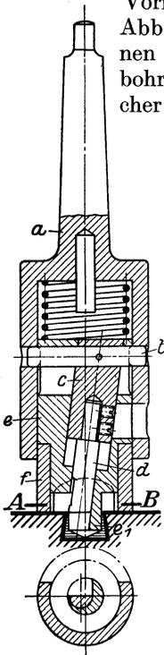
Abb. 52. Kegelbohrer. *a* Kegeldorn, trägt radial beweglich den Bolzen *b* mit dem Schneidstahlhalter *c* und dem Schneidstahl *d* und ferner achsrecht beweglich die unter Federdruck stehende Steuerbüchse *e* mit dem Führungszapfen *e*<sub>1</sub> und der Anschlagbüchse *f*.
