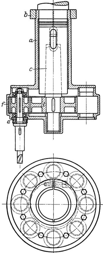
Abb. 59. Mehrspindelbohrkopf auf Kugellager laufend.
