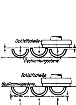
Abb. 98 u. 99. Zum Schleifen falsch und richtig bestimmte Lagerschalen.
