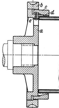
Abb. 12. Spannfutter für größere Spanndurchmesser.
