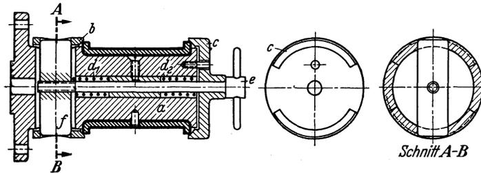
Abb. 103. Fliegende Rundbearbeitung-Spannvorrichtung. a Ausmitt- und Aufnahmedorn. b, c Spannscheiben, werden durch Druckfedern  $d_1, d_2$  auseinander- und durch Spannschraube e mit Querstück f zusammengedrückt.
