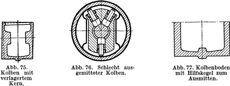
Abb. 75. Kolben mit verlagertem Kern.
