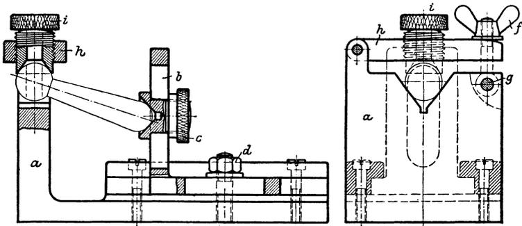
Abb. 142. Fehlerhafte Standbohrspannvorrichtung für Griffmuttern verschiedener Abmessung.
