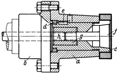
Abb. 18. Tiefspannfutter für Innenspannung. *a* Vorrichtungskörper, mit Drehbankmitnehmerscheibe *b* fest verbunden. *c* Spannzanze, in *a* achsrecht ein wenig beweglich, durch *d* in dieser Bewegung begrenzt und durch Gleitfeder *e* am Verdrehen verhindert. *f* Spreizkegel, durch Doppelmutter *g* mit Kolbenstange *h* des Preßluftspanners fest verbunden.
