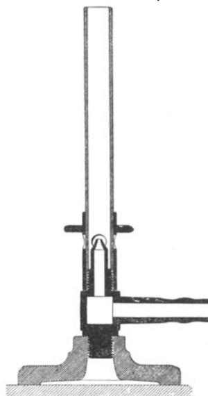
Abb. 1. Schnitt durch einen Bunsenbrenner (Winter).
