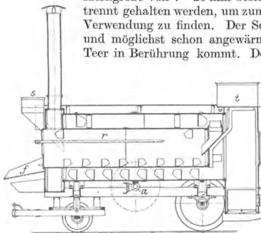
Abb. 25. Teerschotter-Mischmaschine.
