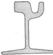
Abb. 207. Phönix-Rillenschiene.
