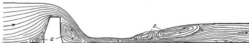
Abb. 20. Schematische Darstellung von Grund- (G) und Deckwalzen (D). (Nach REHBOCK.)
