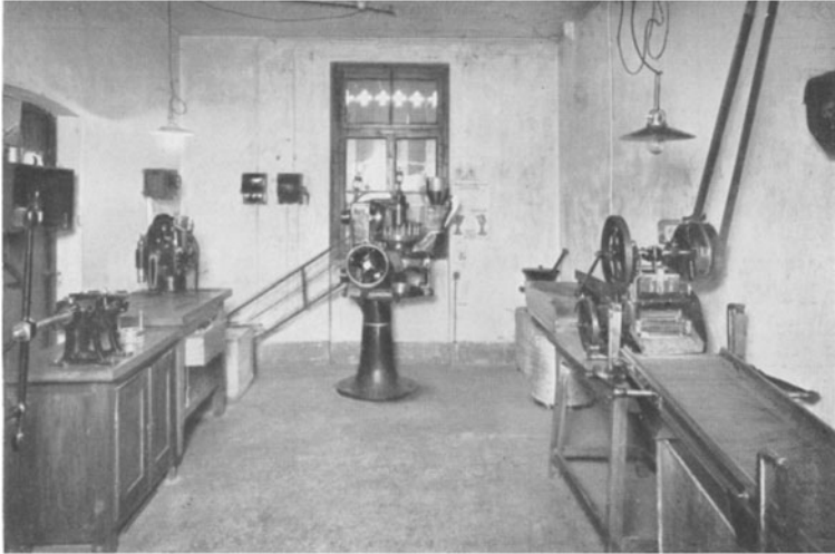
Abb. 2. Teilansicht des Maschinenlaboratoriums der Städt. Katharinenhospitalapotheke, Stuttgart. Suppositorienpresse, kleine, große Tablettenmaschine, Drogenschneidmaschine.
