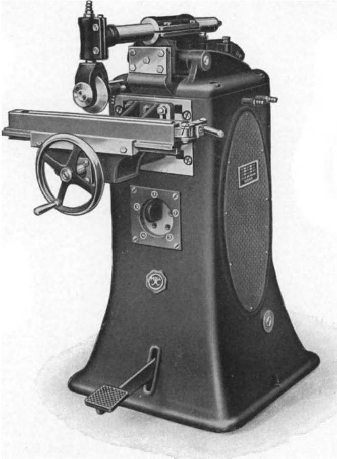
Abb. 181. Schweißmaschine mit Spezial-Quernahtschlitten.
