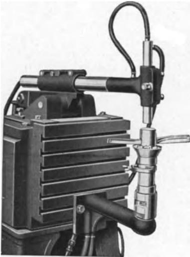
Abb. 228. Punktschweißmaschine mit Schmelzvorrichtung.
