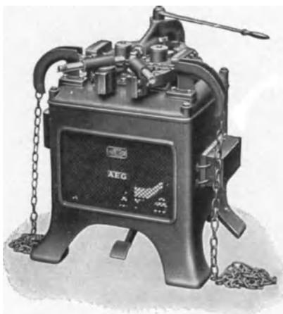
Abb. 130. Kettenschweißmaschine mit horizontaler Führung und Handbetätigung.
