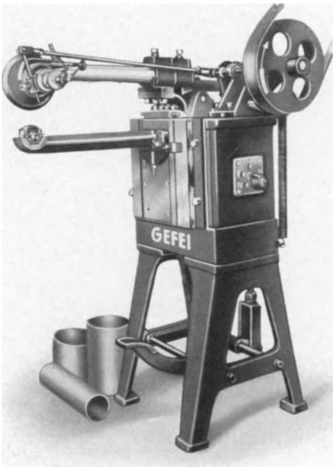
Abb. 191. Längsnahtrollenschrittmachine 12 kVA.
