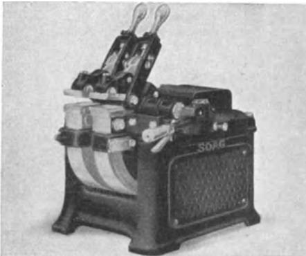
Abb. 111. Stumpfschweißmaschine in Tischform.
