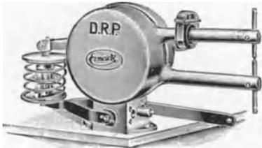
Abb. 157. Kleine Punktschweißmaschine
