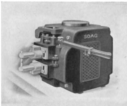
Abb. 159. Tischpunktmaschine 2 KW.
