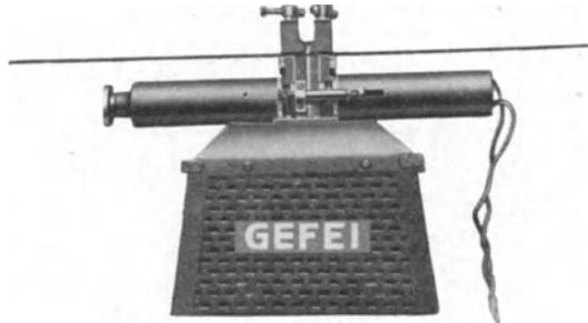
Abb. 109. Stumpfschweißmaschine 2 kVA.
