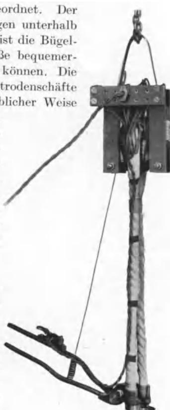
Abb. 160. Hängende Spezialpunkt-schweißmaschine.
