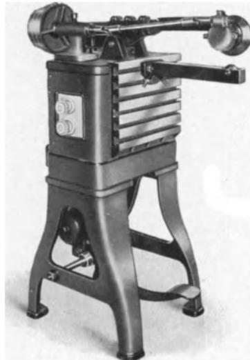
Abb. 183. Längsnahtschweißmaschine.
