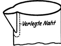
Abb. 224. Verlegung der Naht aus der Kante zur Verhütung der Bläschenbildung.
