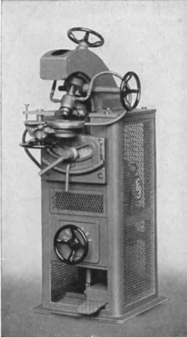
Abb. 172. Stahlplättenschweißmaschine.
