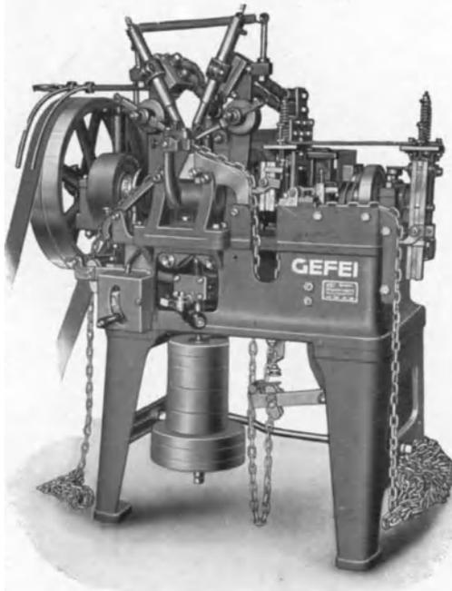
Abb. 131. Automatische Kettenschweißmaschine.
