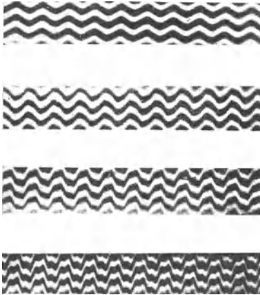
Abb. 65. Dichteschwankungen in einer gedackten Orgelpfeife. (Nach A. RAPS.)
