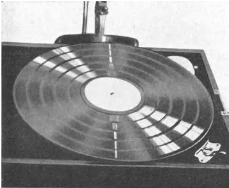
Abb. 174. Breite des Lichtreflexes („Meyerbreite“), verschieden stark angesteuerter Teile einer Schallplatte. (Die Reflexionen liegen längs des in der Abbildung senkrecht verlaufenden Plattendurchmessers, nach G. BUCHMANN und E. MEYER.)
